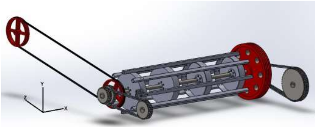
Fig. 3 Detalle de los sistemas de acople sobre el eje del cilindro secundario trillador
