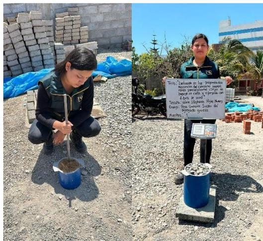
Fig. 16. Ensayo de peso unitario suelto y compactado del agregado fino y grueso.
