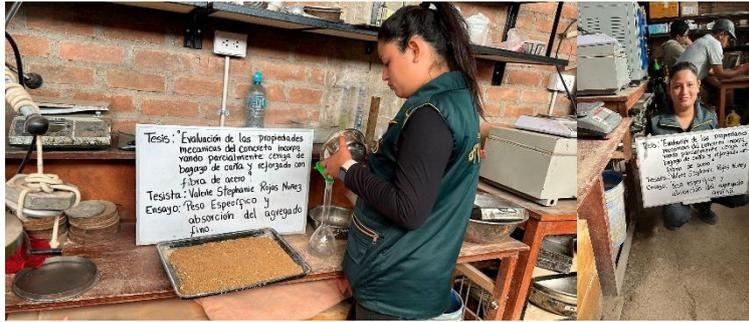
**Fig. 17.** Ensayo de peso específico y absorción del agregado fino y grueso.
