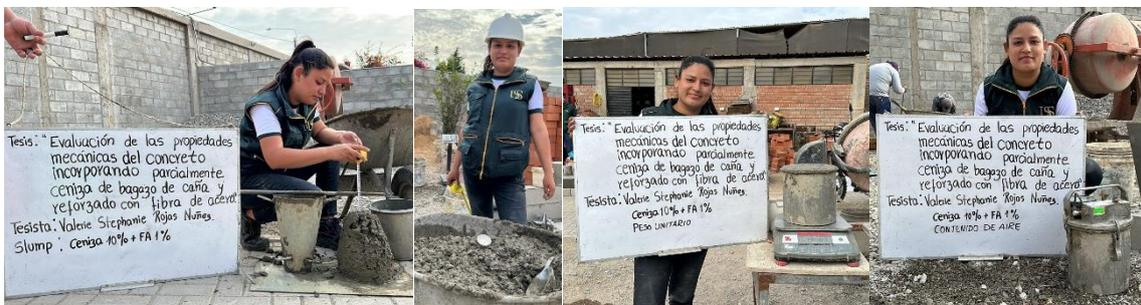
**Fig. 20.** Asentamiento, temperatura, peso unitario y contenido de aire del concreto.
