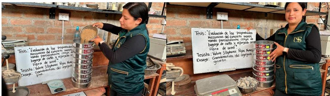
Fig. 15. Ensayo de granulometría de agregado fino y grueso.
