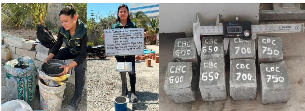
Fig. 13. Tamizado, peso unitario suelto y compactado, cubos de concreto para índice puzolánico de CBC.
