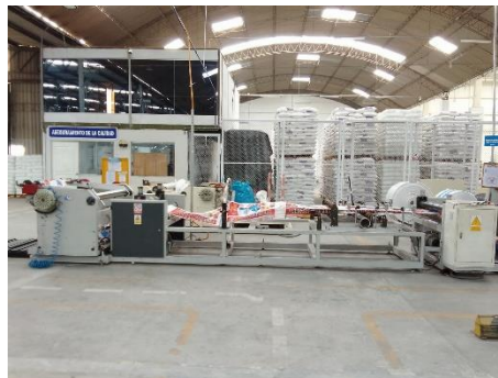
Fig. 11 Máquina inversora de manga
