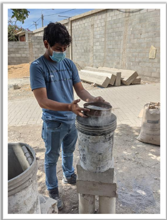
FOTO: OBTENCION DE LAS CENIZAS VOLANTES Y LAS FIBRAS DE ACERO
