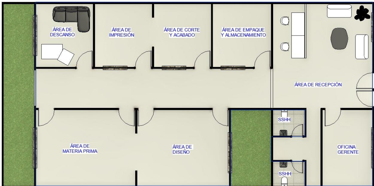
Figura 30. Distribución de planta propuesto de la imprenta
