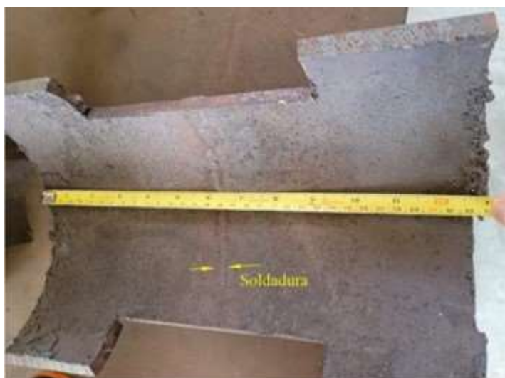
Figura. 9. Acero P5 soldado suministrado por Soldexa
