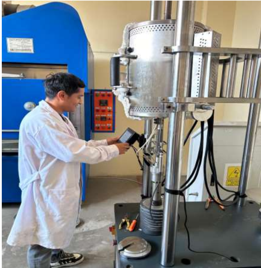
Ilustración 3. Proceso de ensayo al Creep.
