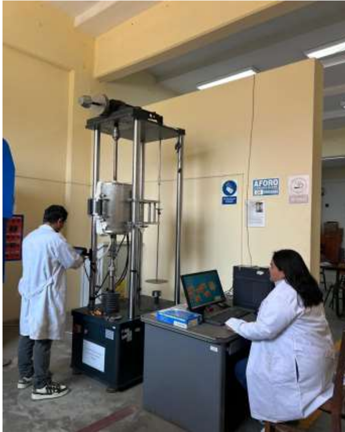
Ilustración 2. Toma de datos mediante el montaje y ensayo al creep.
