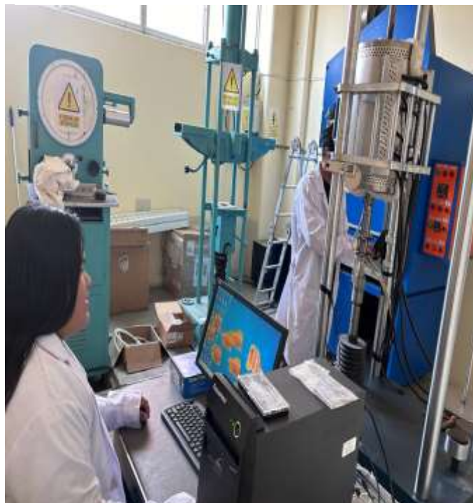
Ilustración 1. Verificación en el sistema sobre el montaje del creep.
