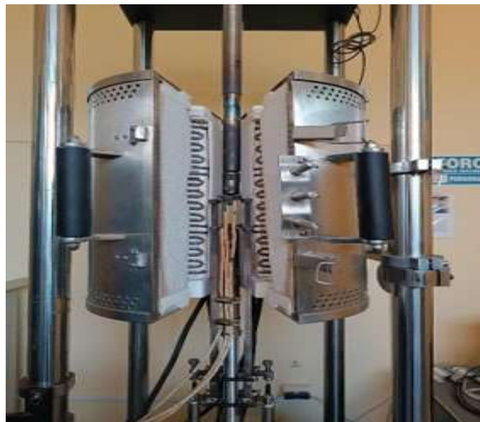
Figura. 11. Montaje y ensayo culminado de creep
