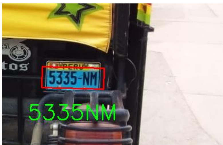
Figura 20. Final del proceso, reconocimiento de caracteres en la placa de mototaxi.
