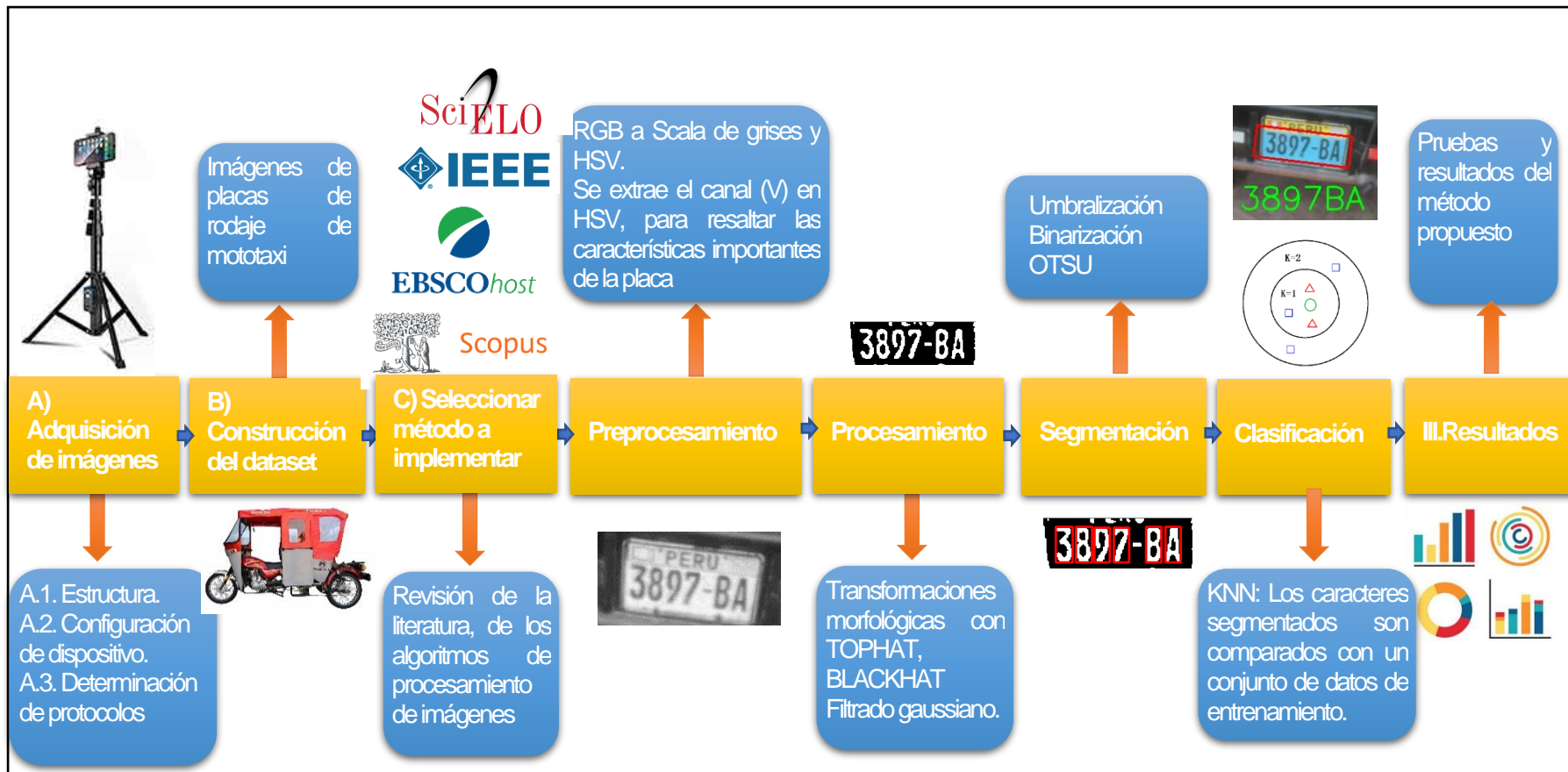
Figura 4. Esquema general del tema del método de reconocimiento de placas de rodaje de mototaxi. Fuente: Elaboración propia.
