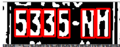
Figura 17. Segmentación de caracteres de la placa. Fuente: Elaboración propia.
