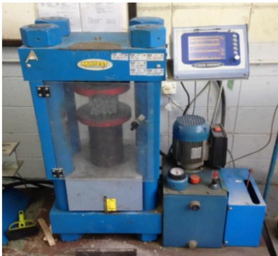
**Fig. 1.** Máquina de Resistencia a la Compresión
