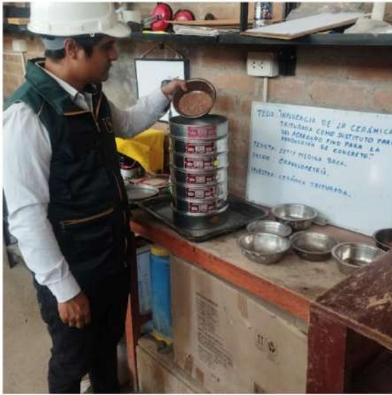
FOTO- Ensayo a la cerámica triturada
