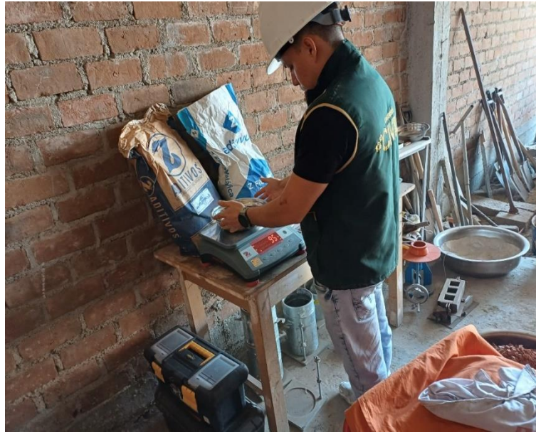
Fig. 3 Pesado de contenido de finos para ver porcentaje qué pasa por el tamiz N°200.
