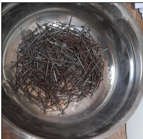
Fig. 1 Ganchos en los extremos-deformación de fibra de acero
