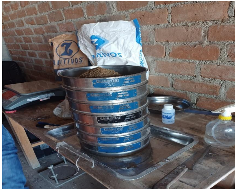
Fig. 1 Ensayo de granulométrico por tamizado. Tamices: N°4, N°8, N°16, N°30, N°50, N°100 y N°200
