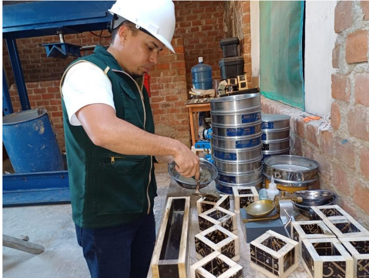
Fig. 11 Llenado de molde para cubos en 2 capas con 32 apisonadas cada una
