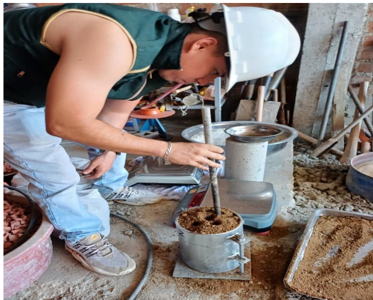
Fig. 4 Varillado del agregado fino 25 golpes cada una en 3 capas
