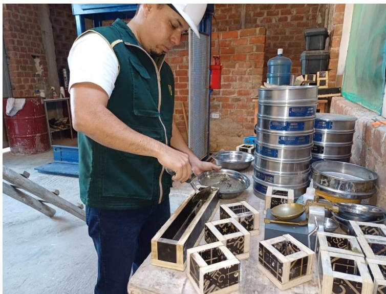
Fig. 12 Llenado de molde para vigas 2 capas con 12 apisonadas cada una
