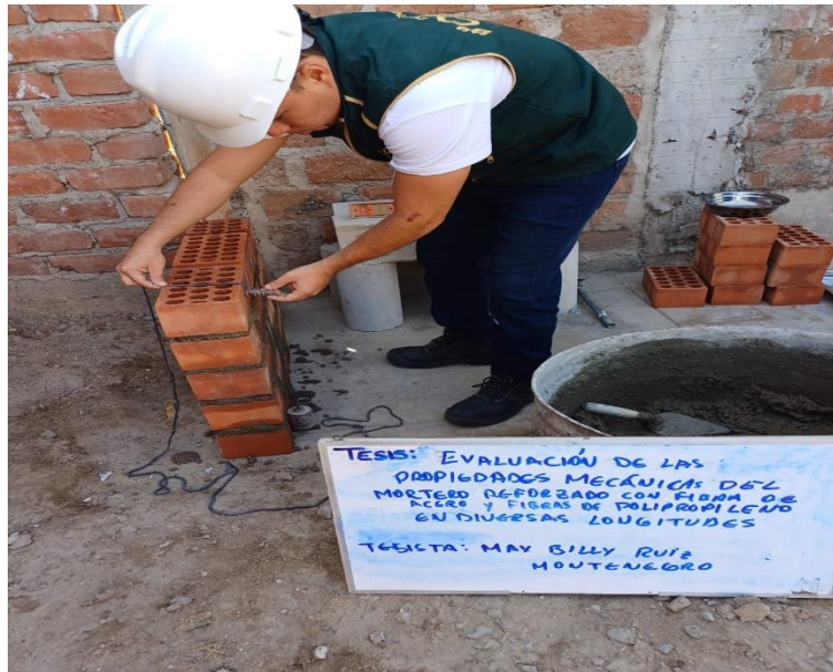
Fig. 17 Plomada para asegurar que las unidades estén niveladas para ensayo de compresión en muretes.
