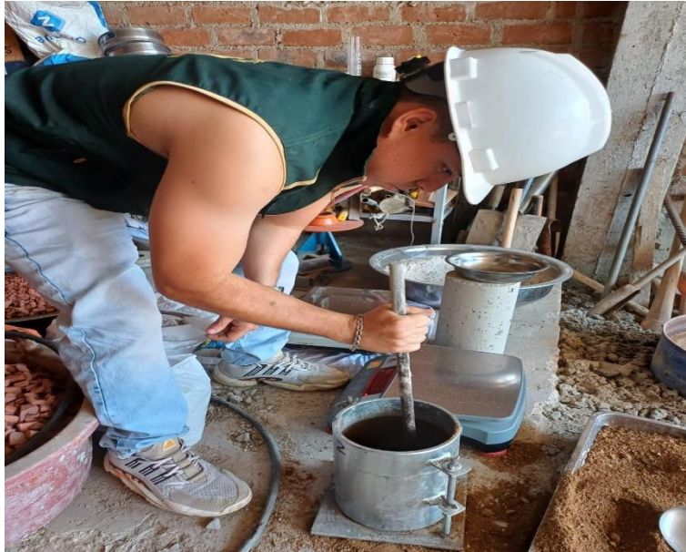
Fig. 5 Varillado agregado fino en tres capas por 25 golpes
