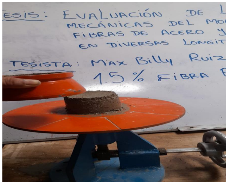
Fig. 8 Ensayo de fluidez llenado de molde con 20 apisonadas cada una en mesa de flujo
