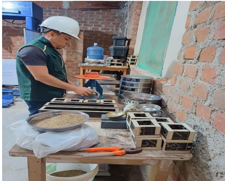
Fig. 7 Ensayo de fluidez en mesa de flujo
