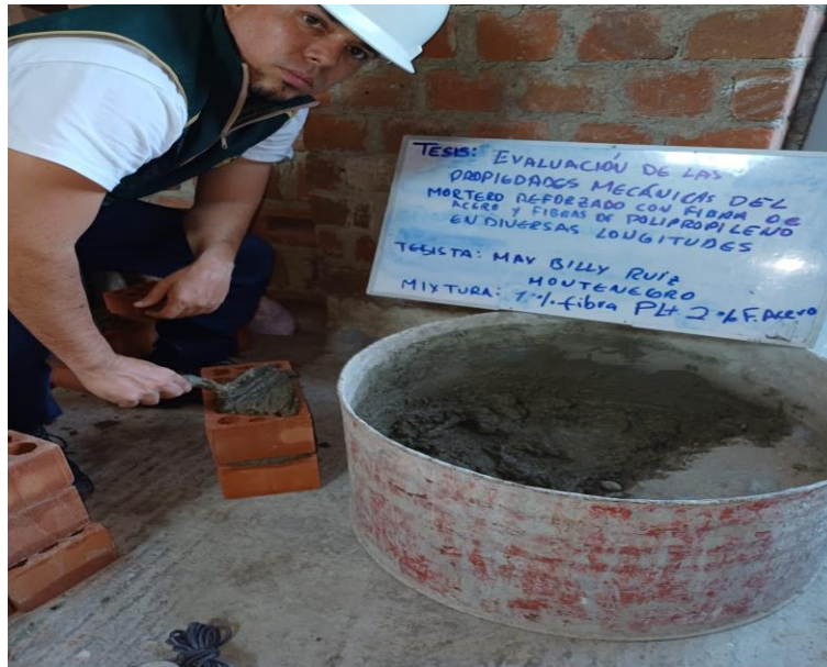
Fig. 15 Colocación de mortero Mixtura:1%FA+2%FPP en pilas
