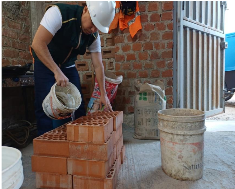
Fig. 14 Humedecimiento de ladrillos para ensayo de pilas y muretes
