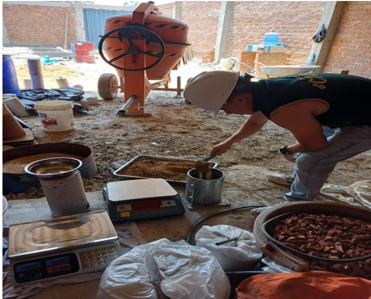
Fig. 6 Llenado de molde sin compactar. El material debe caer por gravedad.
