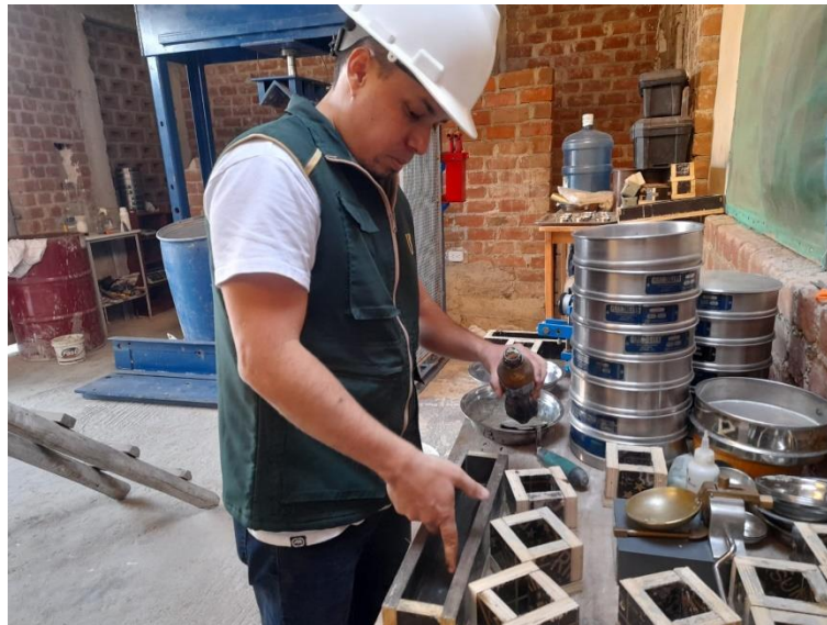
Fig. 10 Llenado de molde para vigas 2 capas con 12 apisonadas cada una
