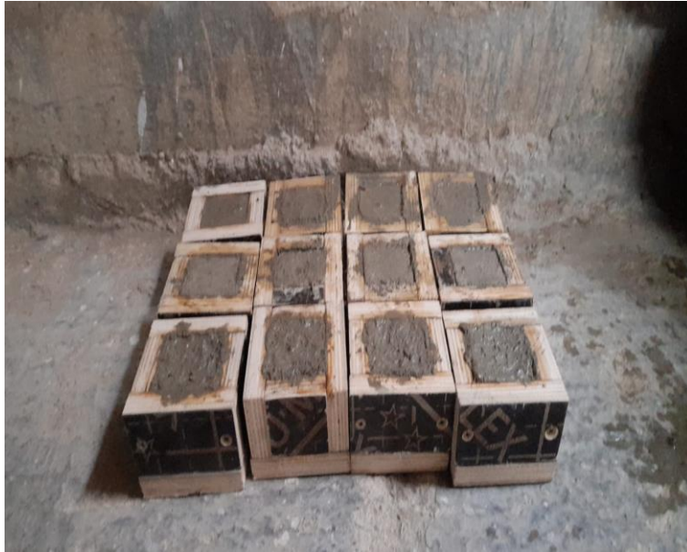
Fig. 13 Llenado de cubos para ensayo a compresión 5cmx5cm
