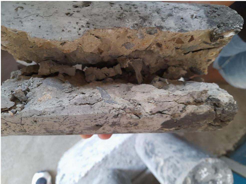
***Ilustración 16. Fibra de cáscara de plátano en el concreto***
