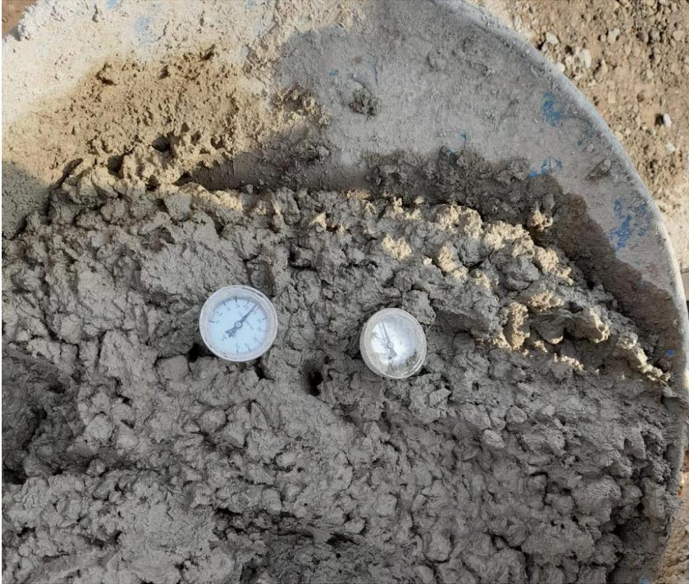
**Ilustración 11. Ensayo de temperatura del concreto**
