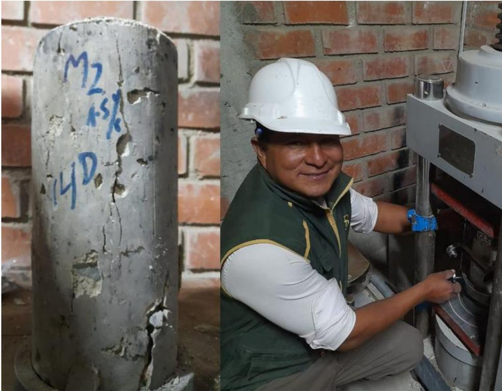
**Ilustración 13. Resistencia a compresión y módulo elástico del concreto**
