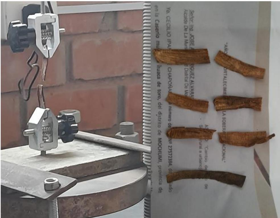
**Ilustración 4. Tensión de la fibra de cáscara de plátano**
