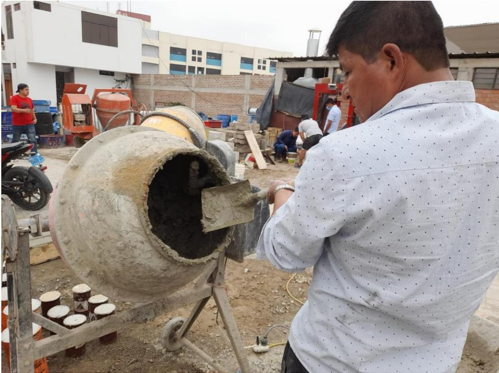
***Ilustración 7. Vaciado de muestras de concreto***
