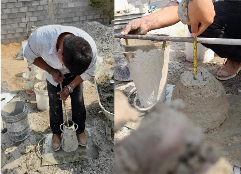
***Ilustración 9. Ensayo de Slump del concreto***
