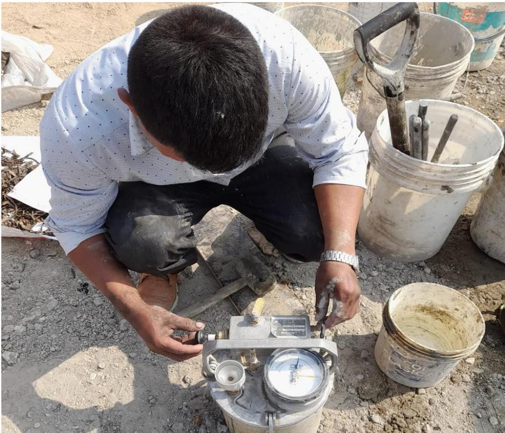
***Ilustración 10. Ensayo de contenido de aire del concreto***
