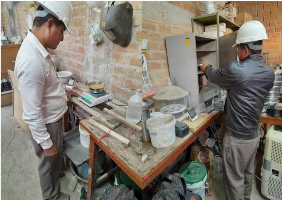
**Ilustración 6. Humedad de los agregados**
