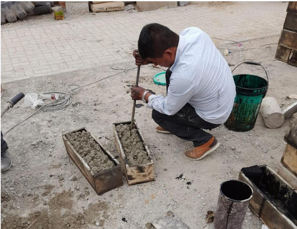
***Ilustración 8. Elaboración de vigas de concreto***
