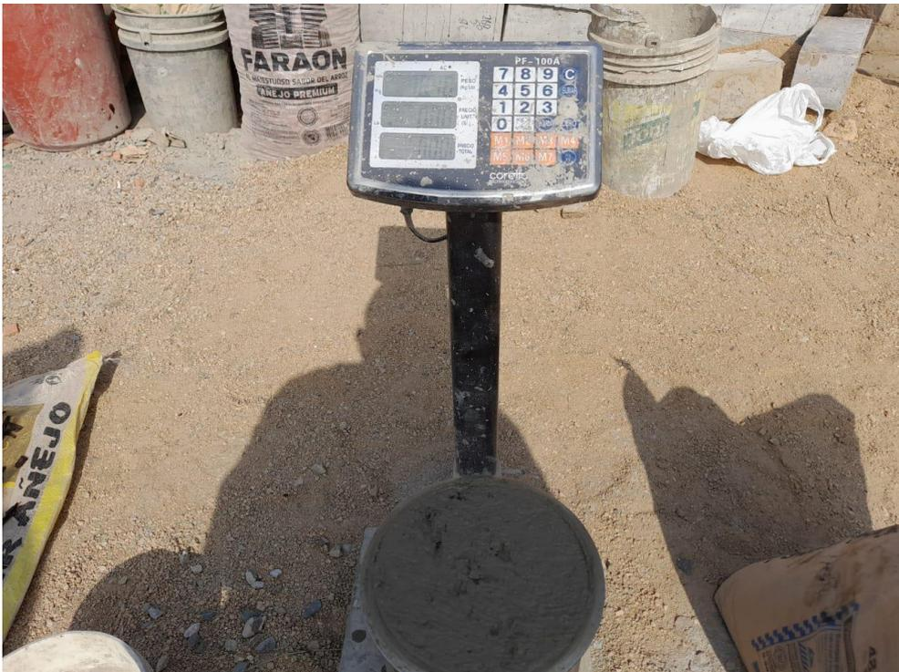
**Ilustración 12. Ensayo de peso unitario del concreto**
