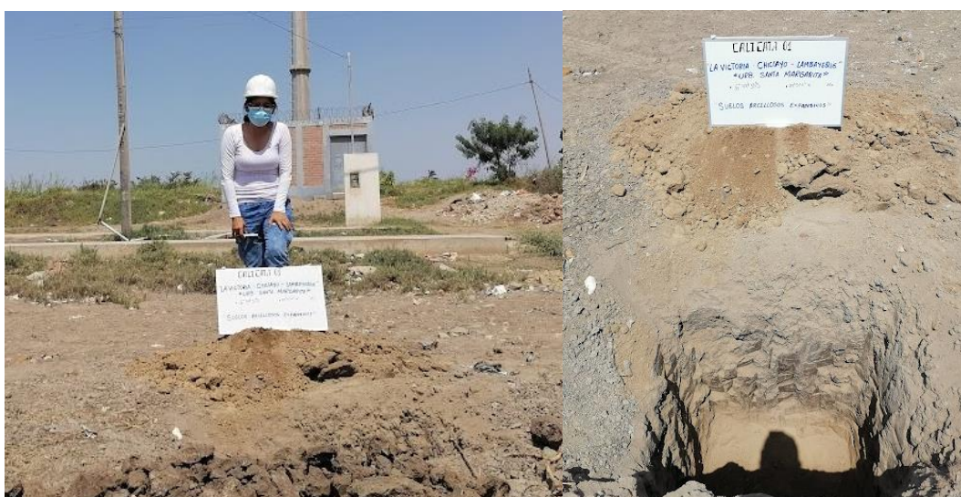
Fig. 2: obtención de muestras, excavación de calicatas.
