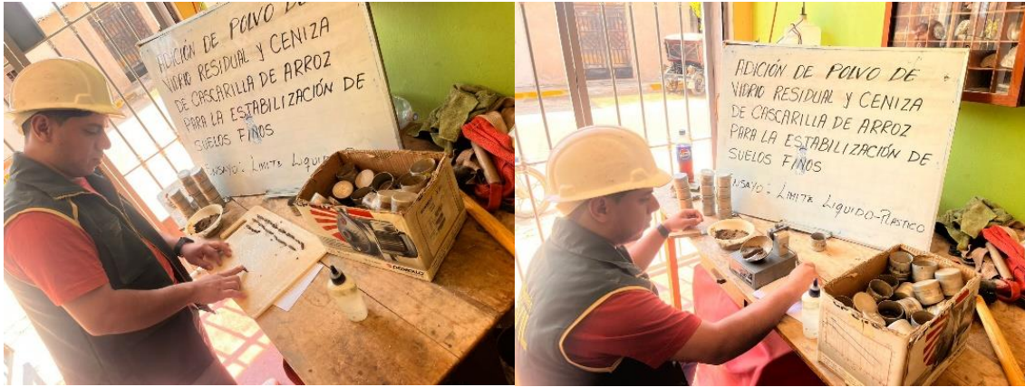
Figura 6: Realización de ensayos de Límites de Atterberg
