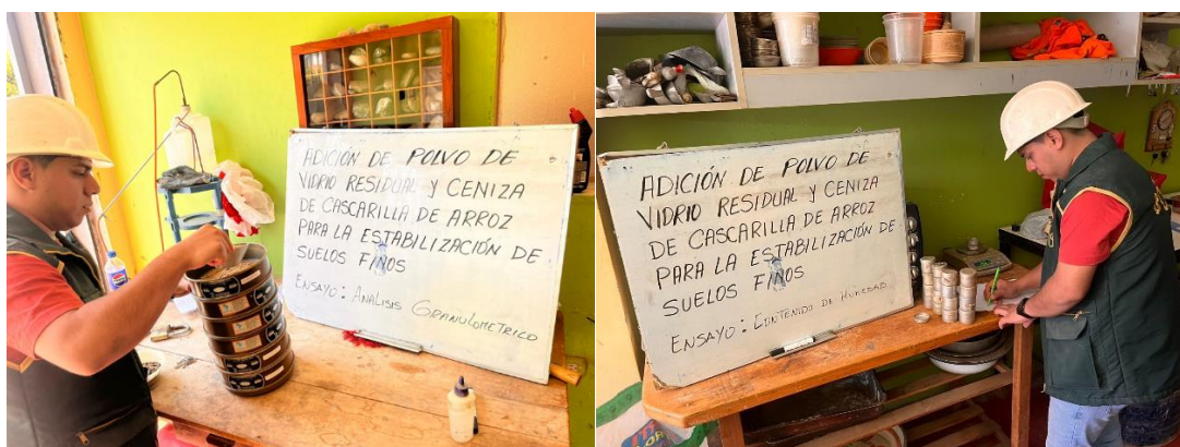
Figura 5: Realización de ensayos granulométricos y contenido de humedad de muestras.
