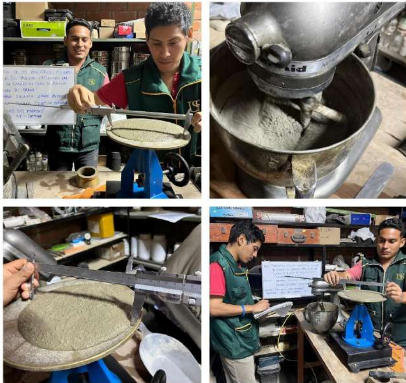
FOTO- Ensayos del mortero en estado fresco (fluidez)
