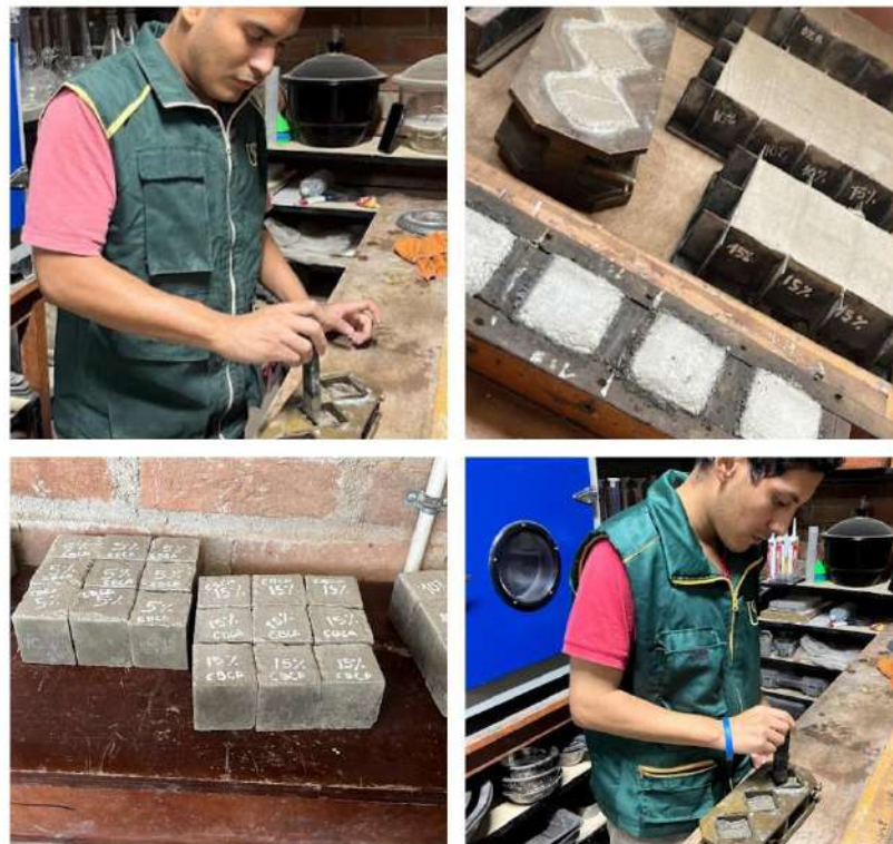
FOTO – Preparación de la mezcla para los ensayos al mortero
