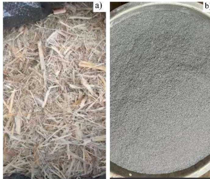
Fig. 1 a) Producto bagazo de caña de azúcar, b) obtención de la CBCA
