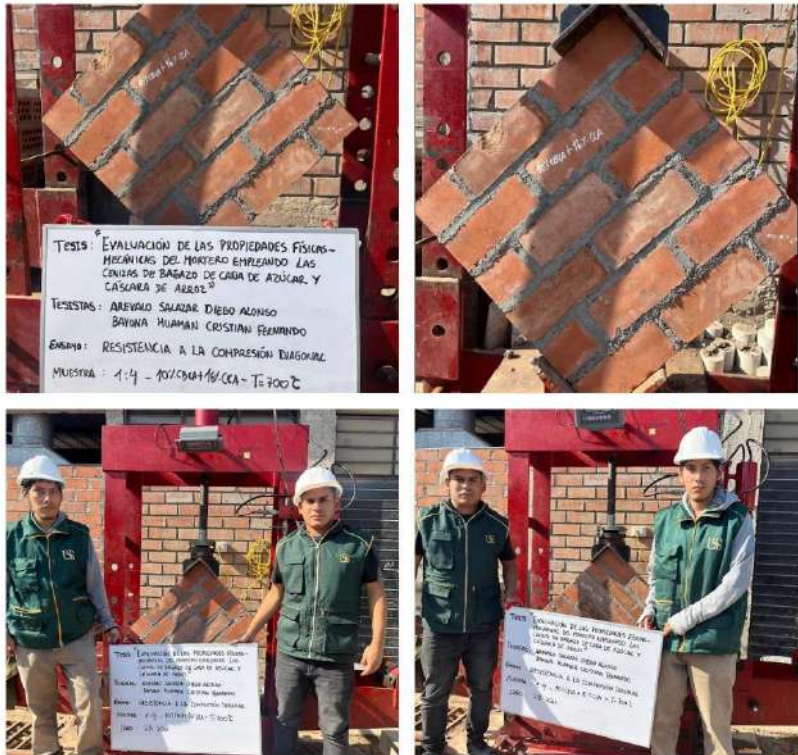
FOTO-Ensayo de resistencia a la compresión diagonal en muros
