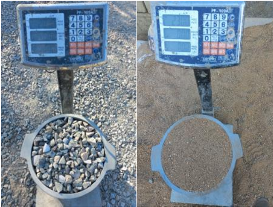
Fig. 12 Ensayo de peso unitario suelto y compactado de los agregados
