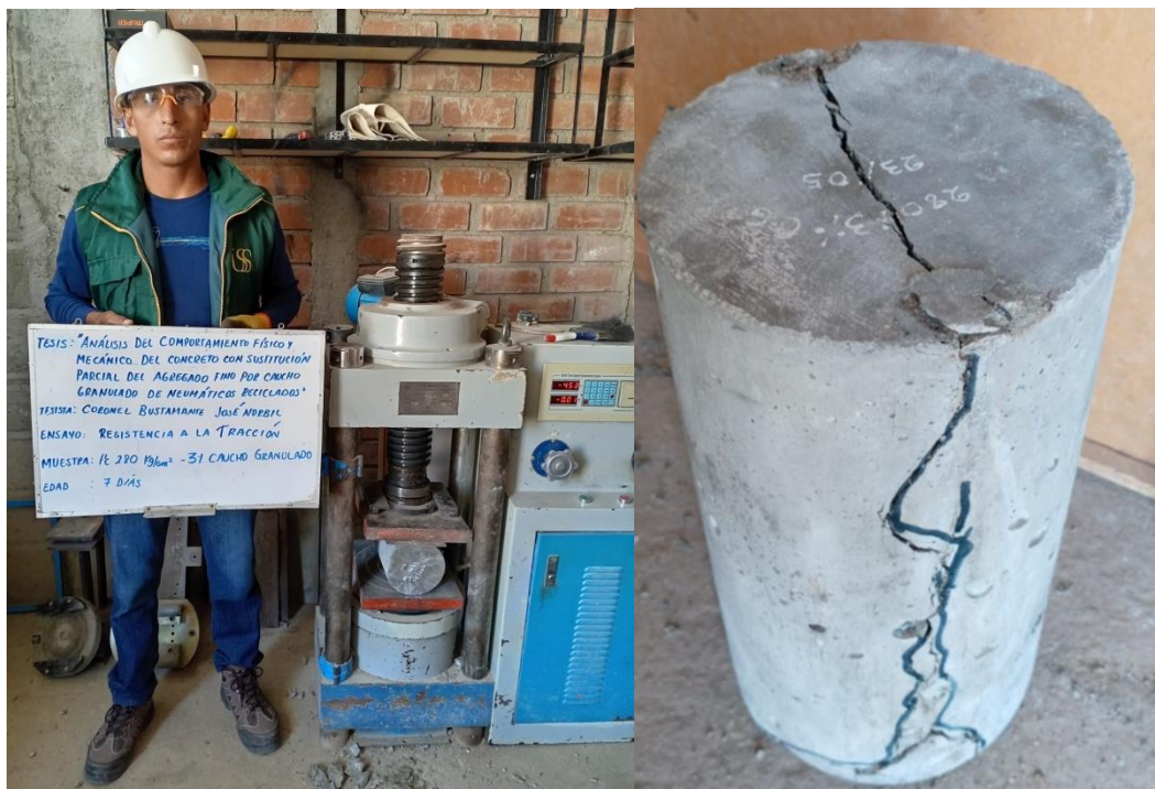
Fig. 25. Ensayo de resistencia a la tracción
