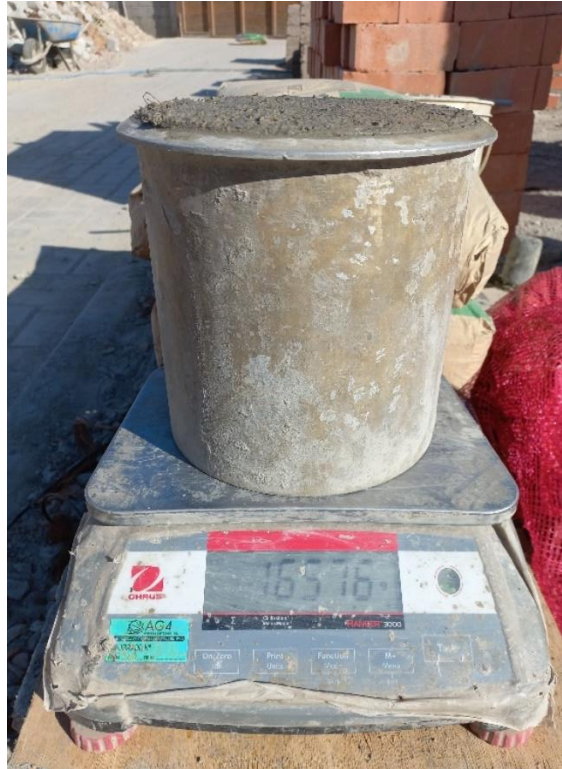
Fig. 22 Ensayo de peso unitario
