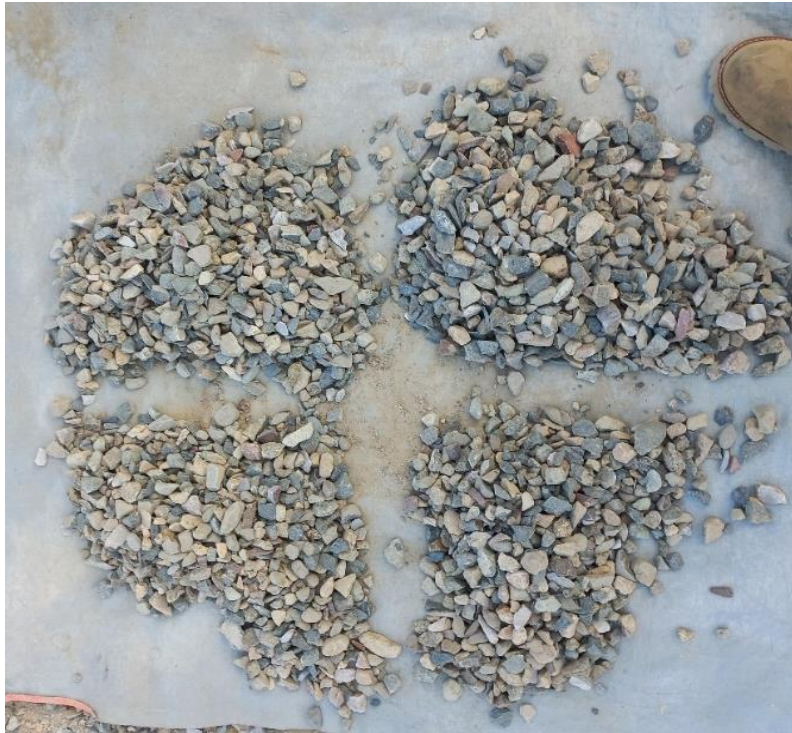
Fig. 14 Cuarteo del agregado grueso
