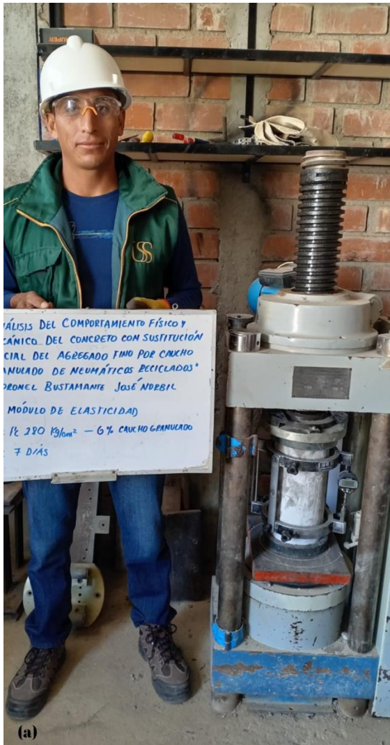
Fig. 27. Ensayo del módulo de elasticidad
