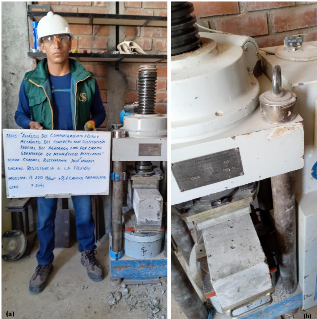
Fig. 26. Ensayo de resistencia a la flexión
