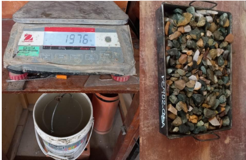
Fig. 18 Ensayo de Peso específico y Absorción del agregado grueso
