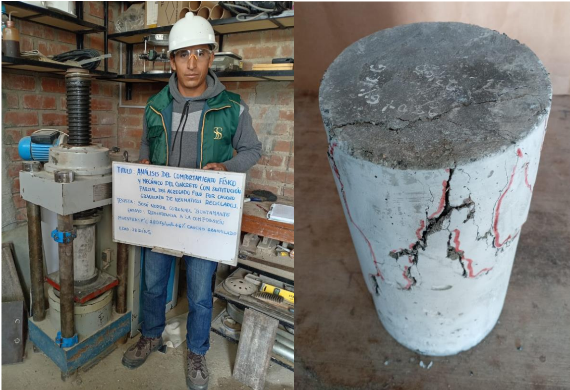
Fig. 24. Ensayo de resistencia a la compresión
