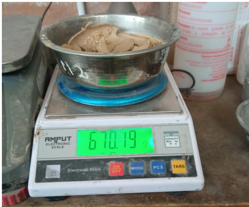
Fig. 15 Muestra sacada del horno del agregado fino
