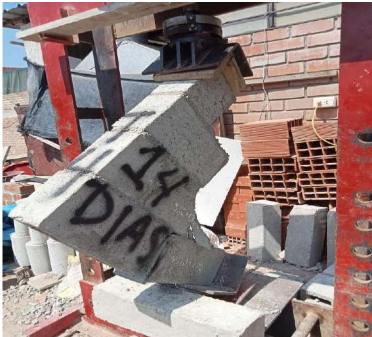
Fotografía 22. Ensayo de compresión diagonal de muretes a los 14 días
