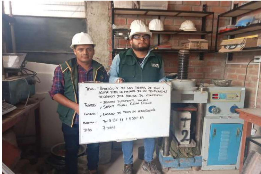
Fotografía 21. Ensayo de compresión de pilas
