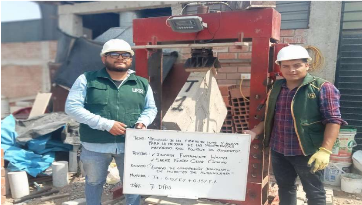
Fotografía 20. Ensayo de compresión diagonal de muretes
