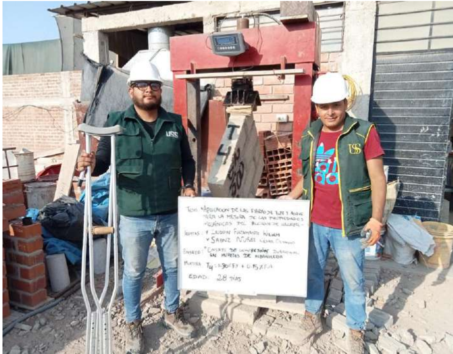
Fotografía 23. Ensayo de compresión diagonal de muretes a los 28 días
