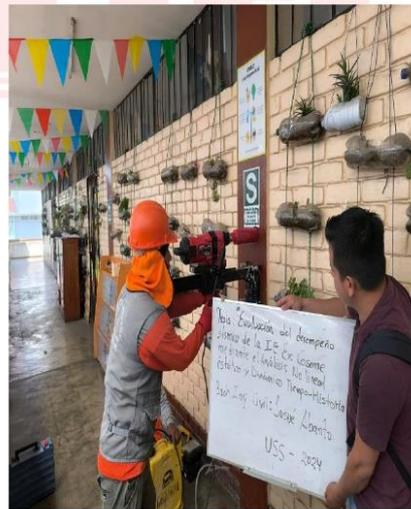
FOTO 04: EXTRACCION DE TESTIGO
