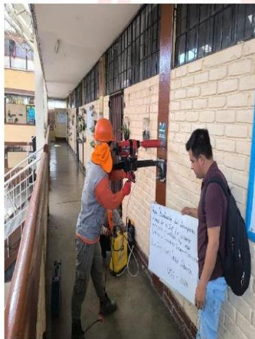
FOTO 03: EXTRACCION DE TESTIGO
