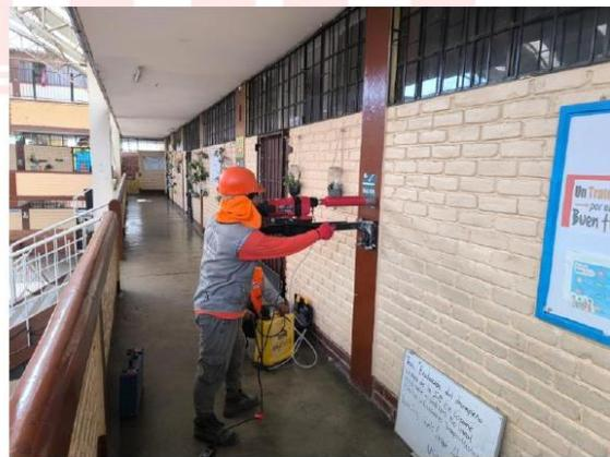
FOTO 08: EXTRACCION DE TESTIGO
