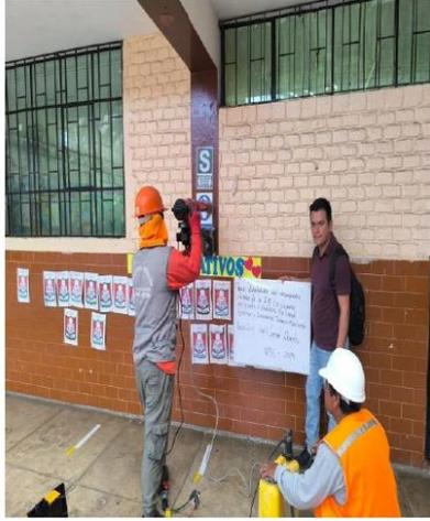
FOTO 09: EXTRACCION DE TESTIGO
