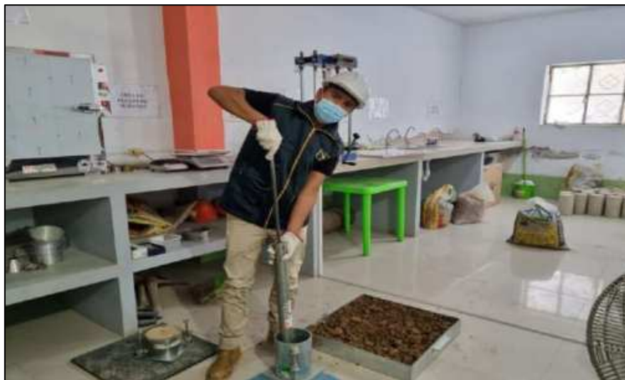
Fig. 14 Compactación del suelo para el ensayo de Proctor modificado
