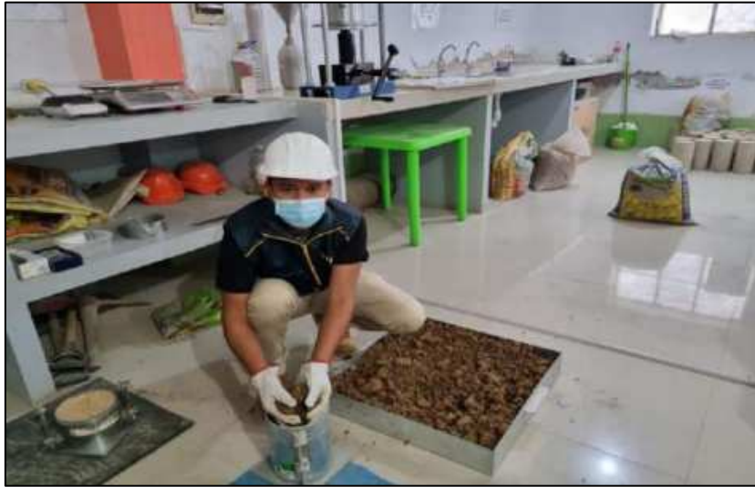
Fig. 13 Colocación de la muestra al molde de Proctor para su compactación
