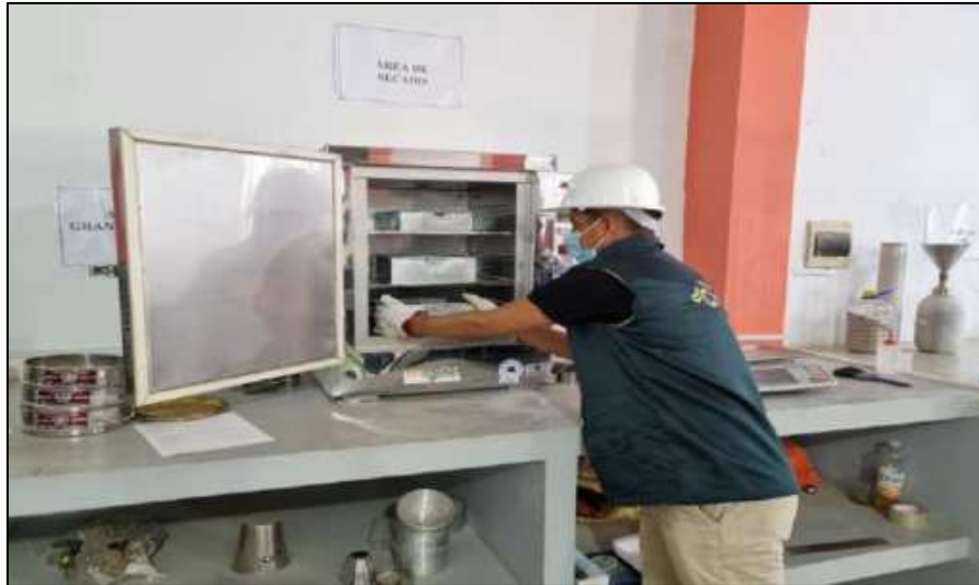
Fig. 11 Secado de la muestra para el contenido de humedad
