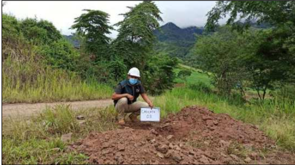
Fig. 9 Toma de muestra del suelo natural
