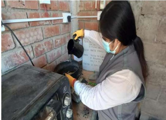
Fig. 33. Mezcla de los agregados y asfalto para la elaboración de briquetas.
