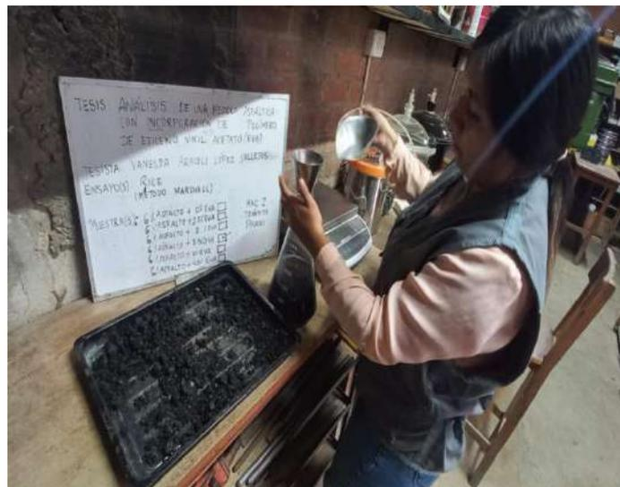
Fig. 29. Colocación de asfalto para el ensayo de Rice.
