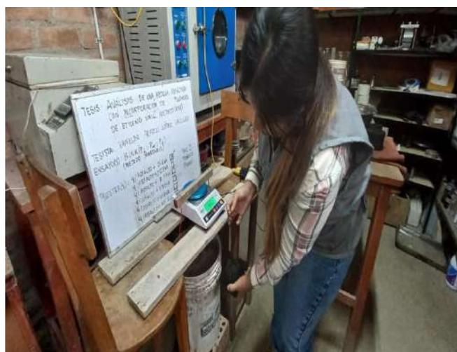
Fig. 35. Colocación de briketa para determinar su peso sumergido.
