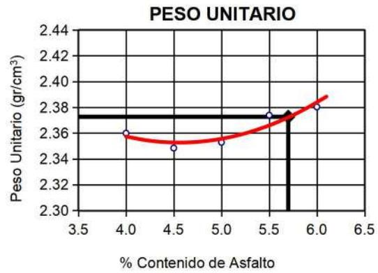
Fig. 13. Contenido de Asfalto vs Peso Unitario.
