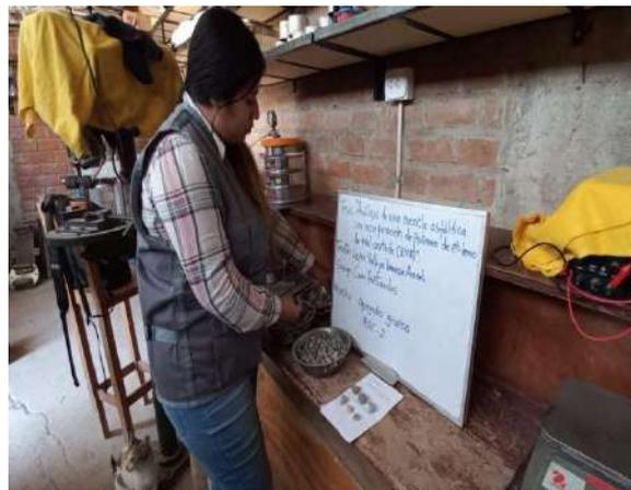
Fig. 22. Selección del agregado para ensayo de caras fracturadas.
