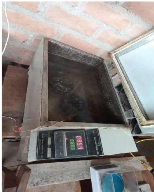
Fig. 37. Baño de agua de las muestras a 60°C.
