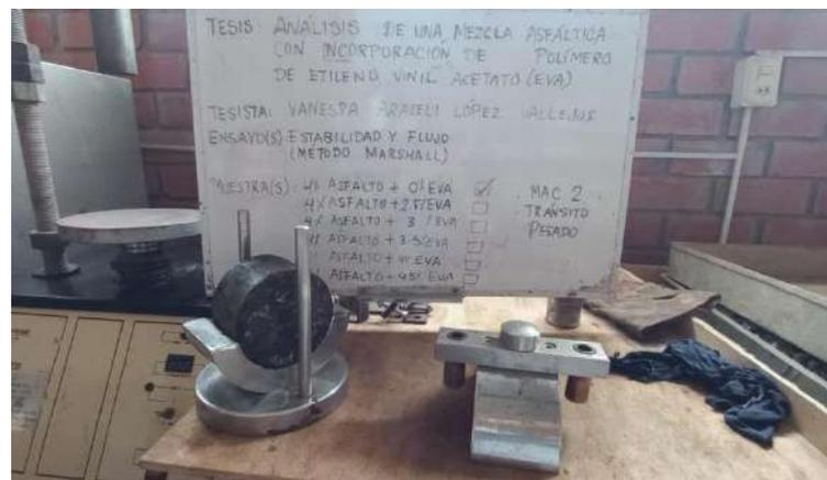
Fig. 38. Colocación de la briqueta en la mordaza.
