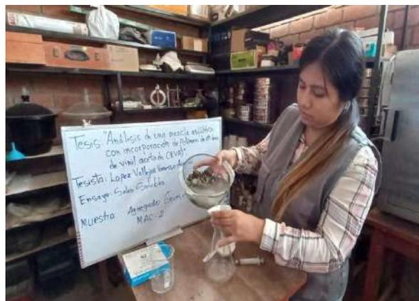
Fig. 23. Ensayo de contenido de sales solubles para agregado grueso.
