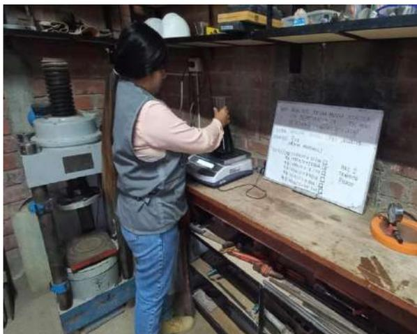
Fig. 30. Peso de la muestra para el ensayo de Rice.
