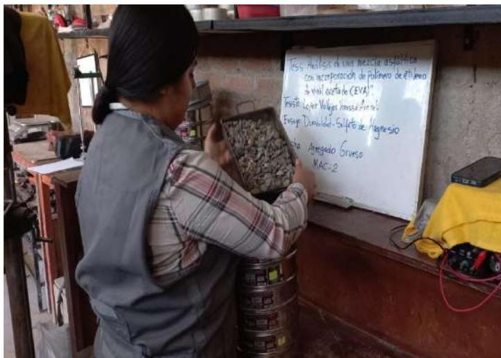
Fig. 24. Ensayo de durabilidad para agregado grueso.
