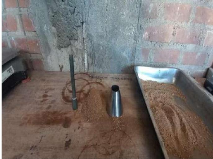
Fig. 27. Ensayo de peso específico y absorción del agregado fino.
