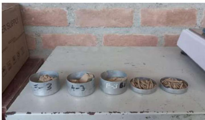
Fig. 25. Ensayo para determinar el límite plástico
