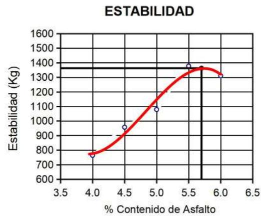
Fig. 11. Contenido de Asfalto vs Estabilidad.
