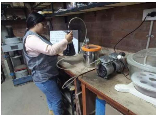
Fig. 31. Retiro del contenido de vacíos en el ensayo de Rice.
