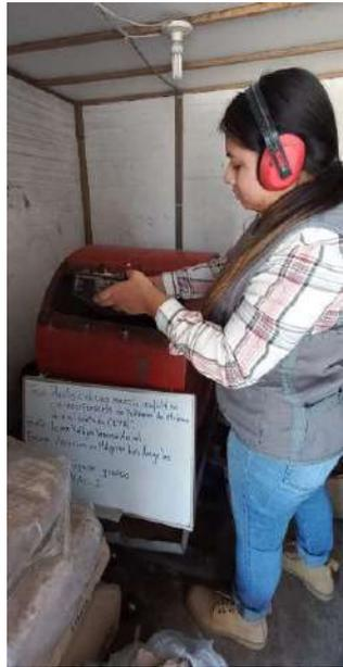
Fig. 21. Ensayo de abrasión en máquina Los Ángeles.
