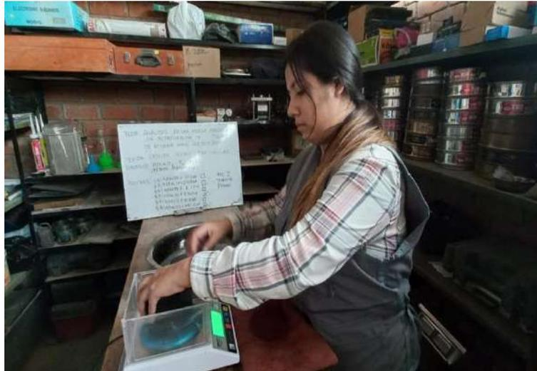
Fig. 36. Peso superficialmente seco de la briqueta.
