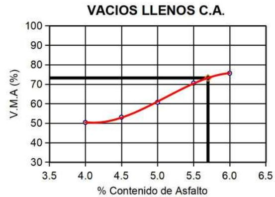
Fig. 8. Contenido de Asfalto vs % V.LL.C.A.
