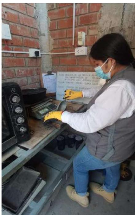
Fig. 32. Peso de los agregados para la elaboración de briquetas.
