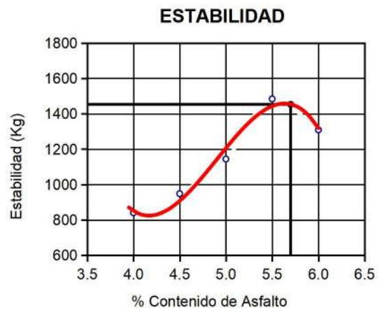
Fig. 19. Contenido de Asfalto vs Estabilidad.
