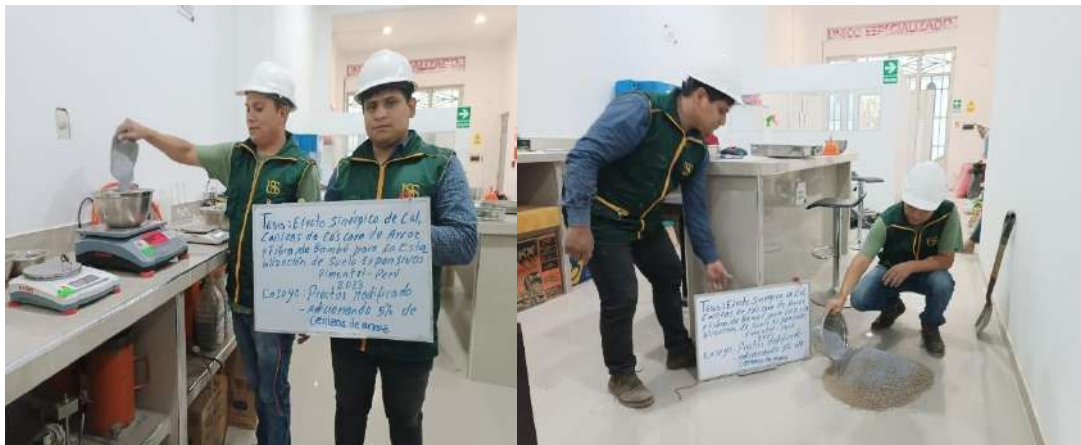
Ilustración 9. Ensayo de Proctor Modificado del suelo más 5% CCA.
