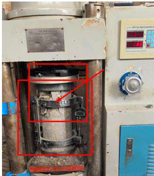
fig. 13 rotura de probetas módulo de elasticidad
