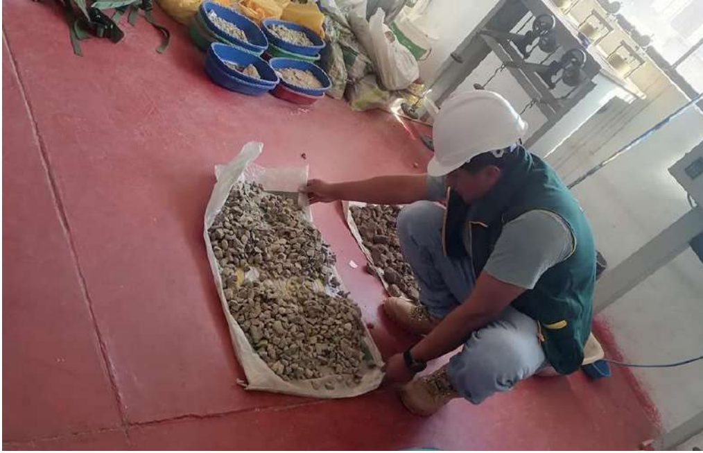
fig. 03 Cuarteo del material (agregado grueso)
