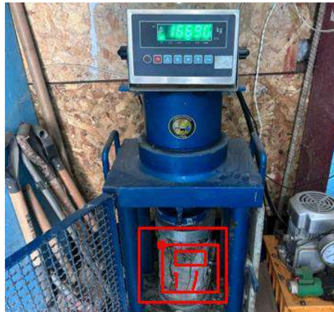
fig. 09 roturas de probetas resistencia a la compresión
