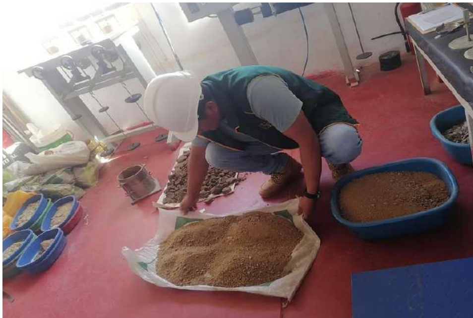
fig. 04 cuarteo de material (agregado fino)
