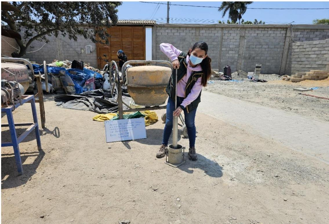
Fotografía 9. Compactación para penetración.
