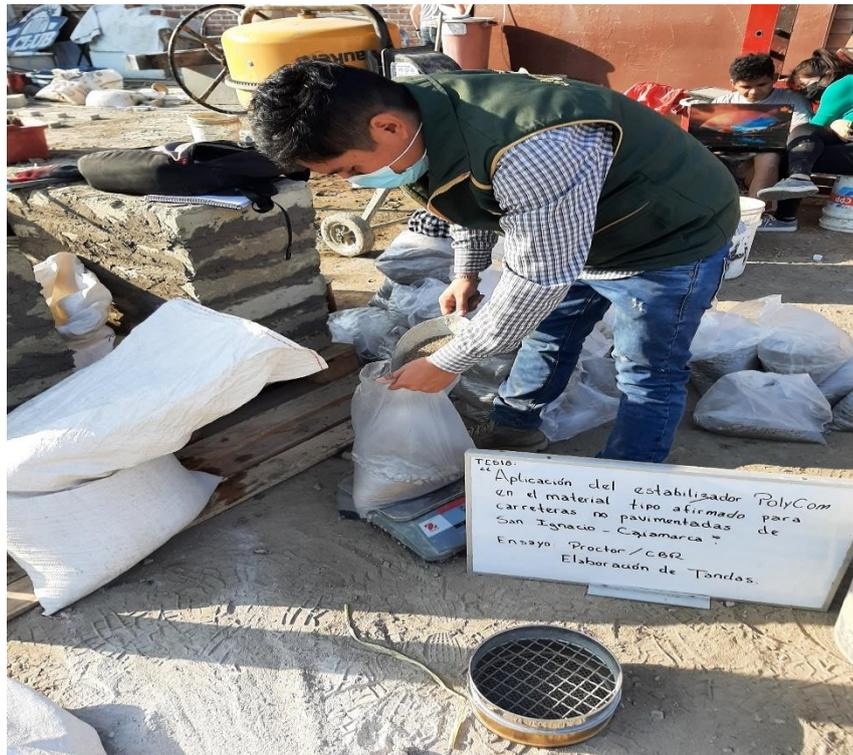
Fotografía 8. Ensayo Proctor (Muestra Guía).
