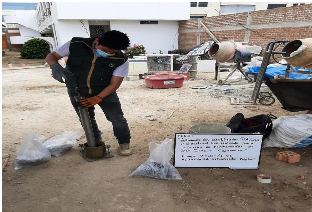
Fotografía 15. Saturación del afirmado con estabilizador Polycom.
