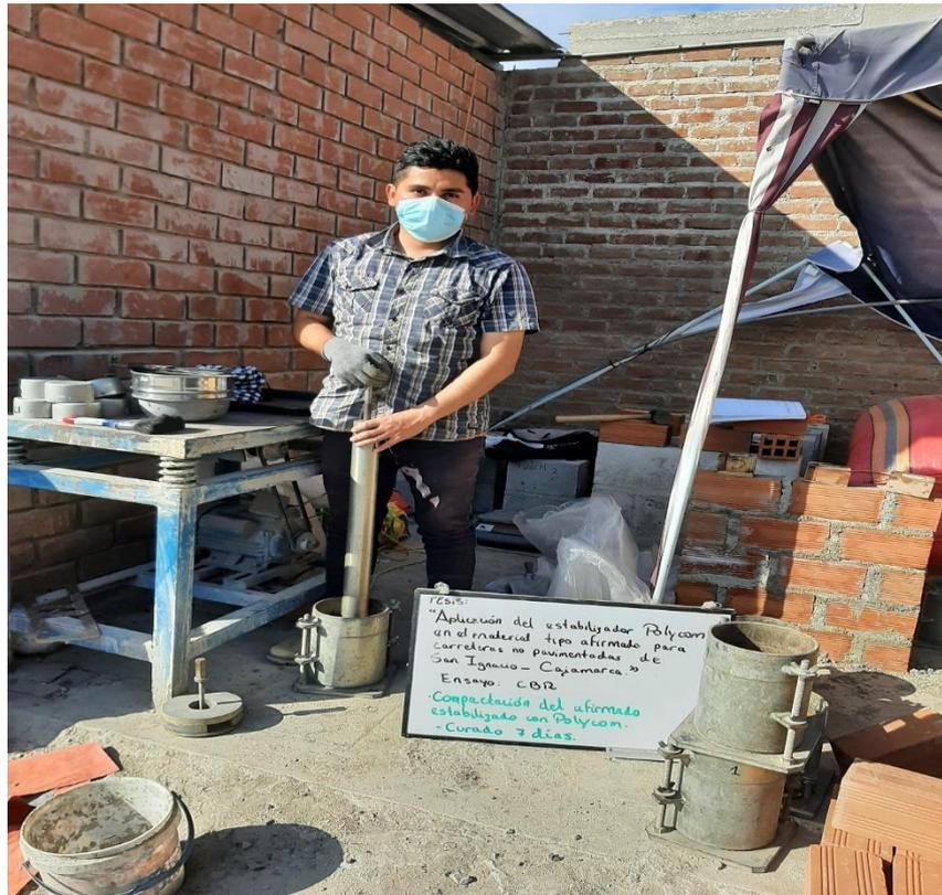
Fotografía 18. Penetración del afirmado con estabilizador Polycom – Curado a los 7 días.
