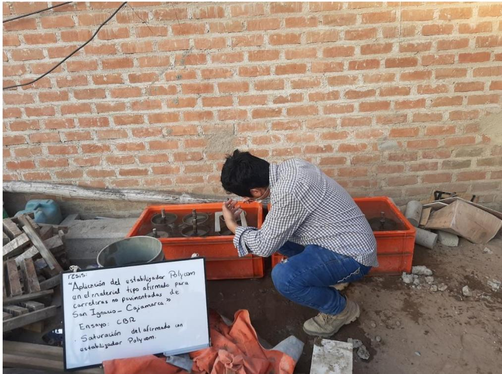
Fotografía 16. Penetración del afirmado con estabilizador Polycom.
