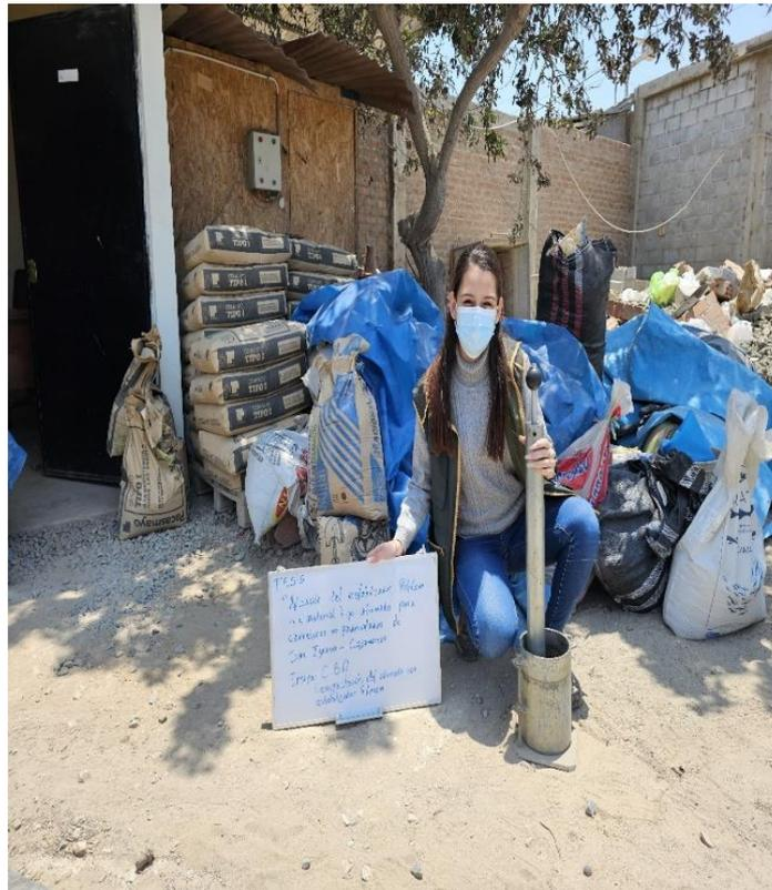
Fotografía 14. Ensayo Proctor / C.B.R (Compactación de afirmado con estabilizador Polycom).
