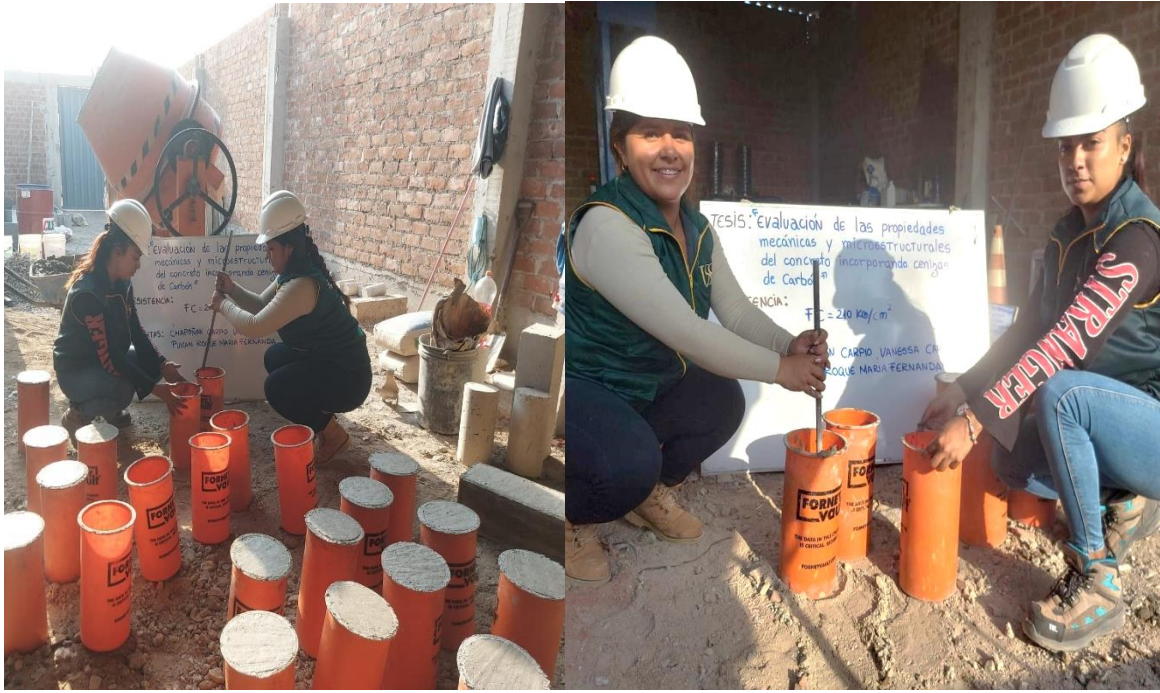
Ilustración 11. Elaboración de muestras de concreto.
