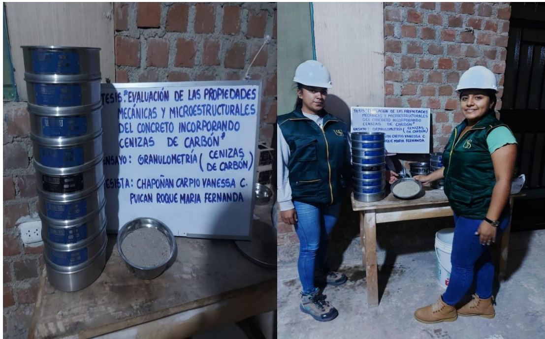
Ilustración 7. Ensayo de granulometría de la ceniza de carbón.
