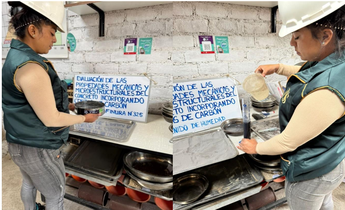
Ilustración 3. Ensayo de índice de finura y contenido de humedad de la ceniza de carbón.
