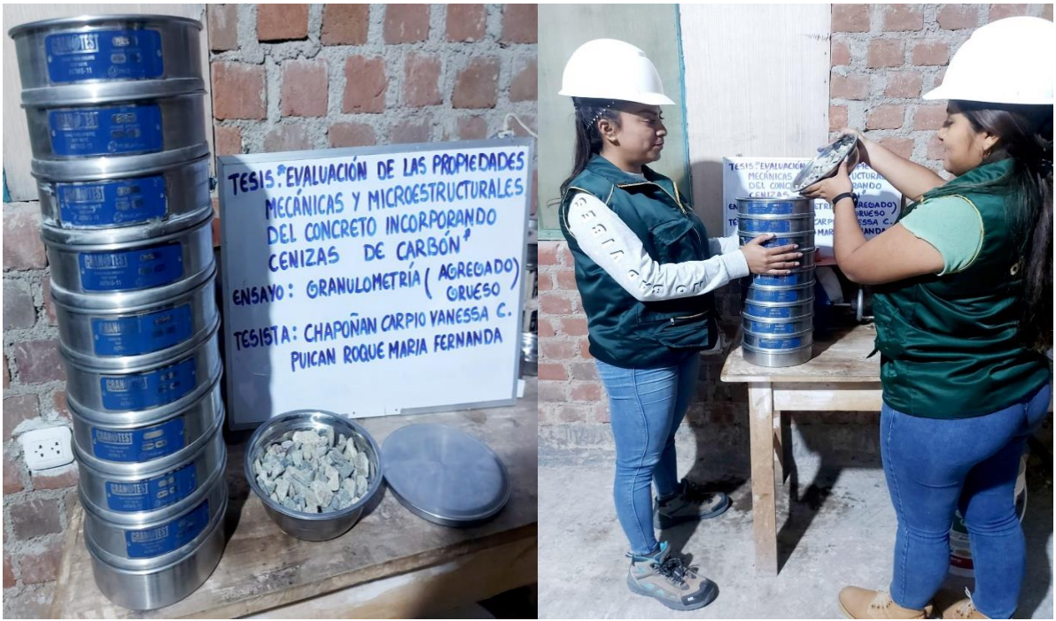
Ilustración 5. Ensayo de granulometría del agregado grueso.
