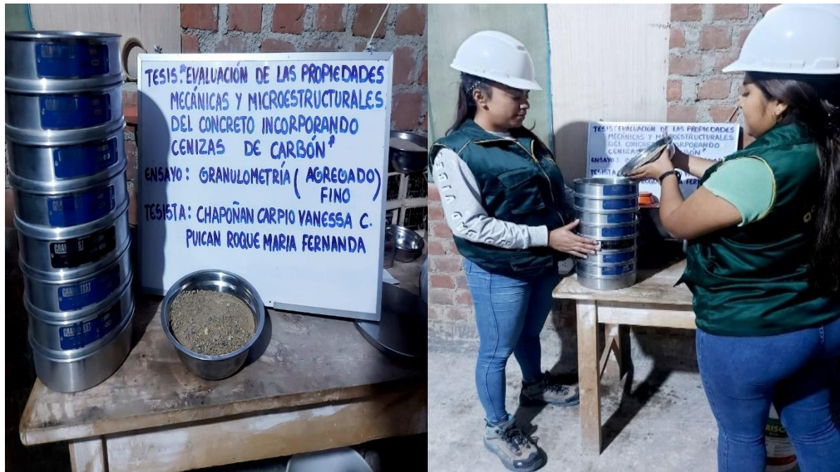
Ilustración 6. Ensayo de granulometría del agregado fino.
