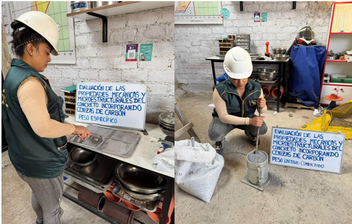
Ilustración 4. Ensayo de peso específico y peso unitario de la ceniza de carbón.
