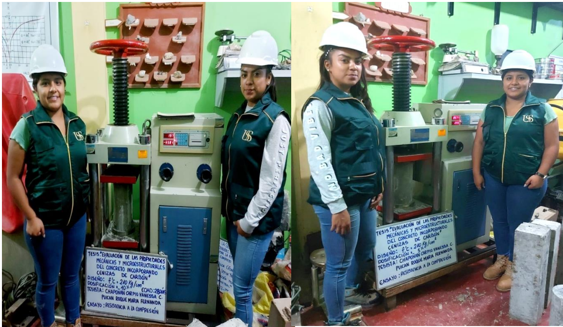
Ilustración 12. Ensayo de resistencia a la compresión.
