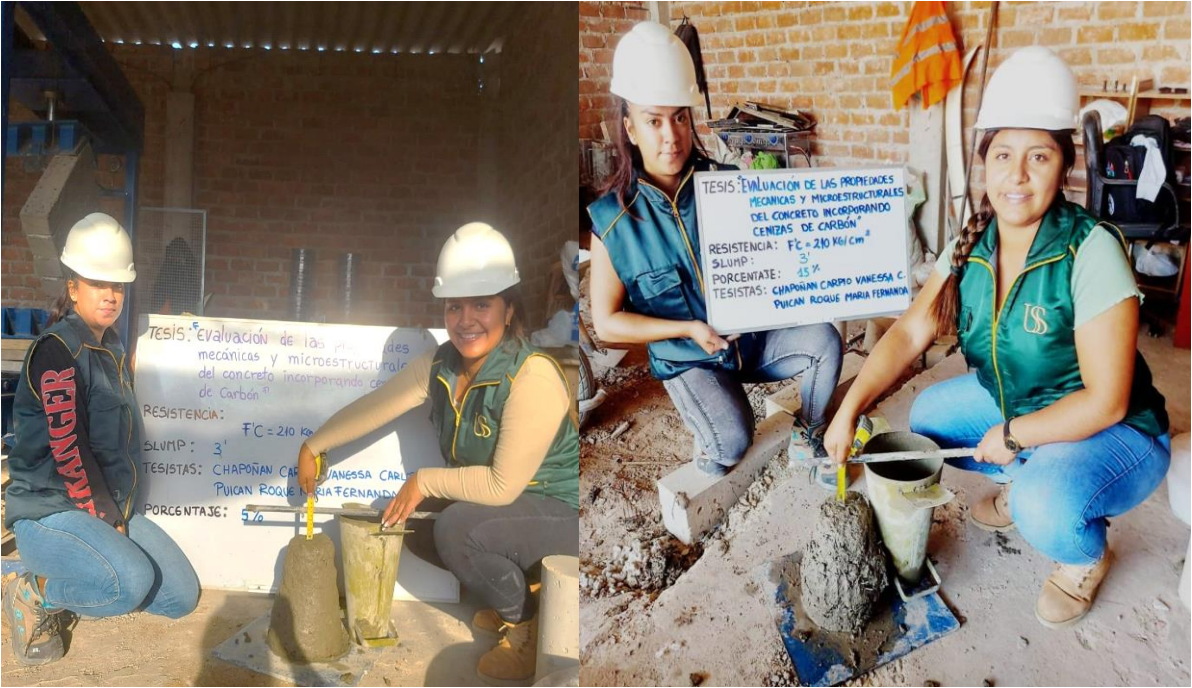
Ilustración 9. Ensayo de slump.
