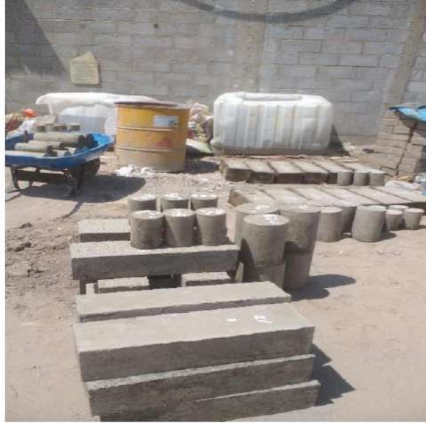
DESENCOFRADO DE MUESTRAS DE CONCRETO
