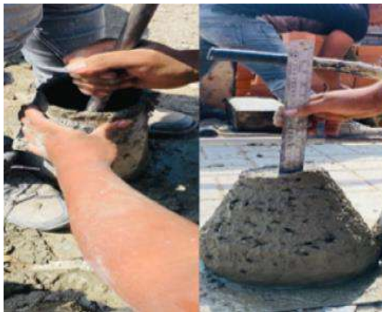
Fig.11. Asentamiento de concreto recién elaborado
