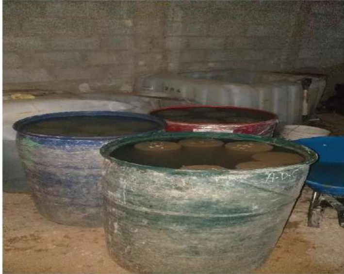
CURADO DE MUESTRAS DE CONCRETO
