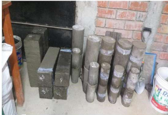
ENSAYO DE MUESTRAS DE CONCRETO A 7 DÍAS DE CURADO
