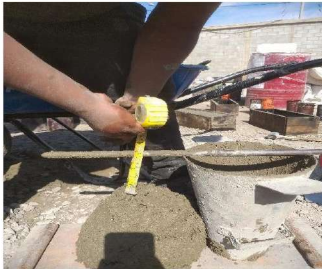
ENSAYO DE SLUPM 4 PULGADAS DE ASENTAMIENTO
