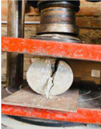
Fig.14. Resistencia a la tracción
