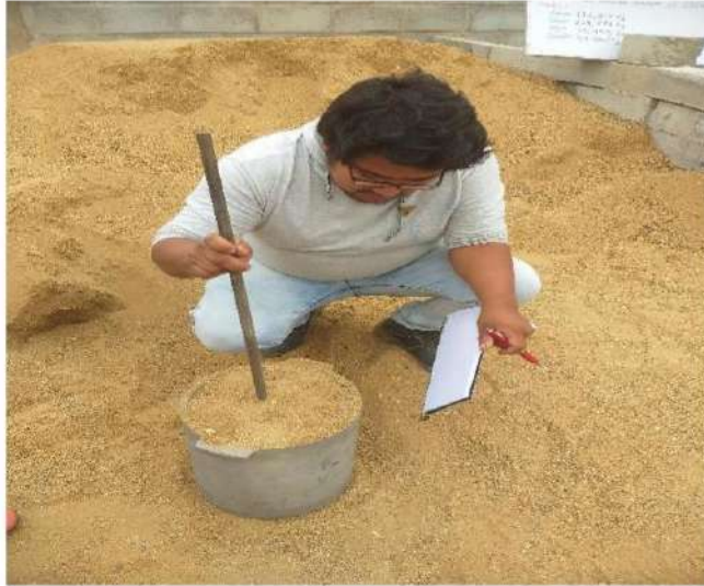
PESO UNITARIO COMPACTADO DE AGREGADO FINO
