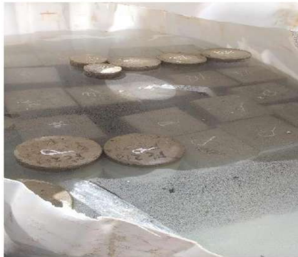
CURADO DE MUESTRAS DE CONCRETO
