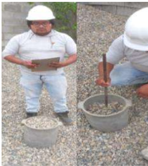
Fig.9. Peso unitario de los agregados
