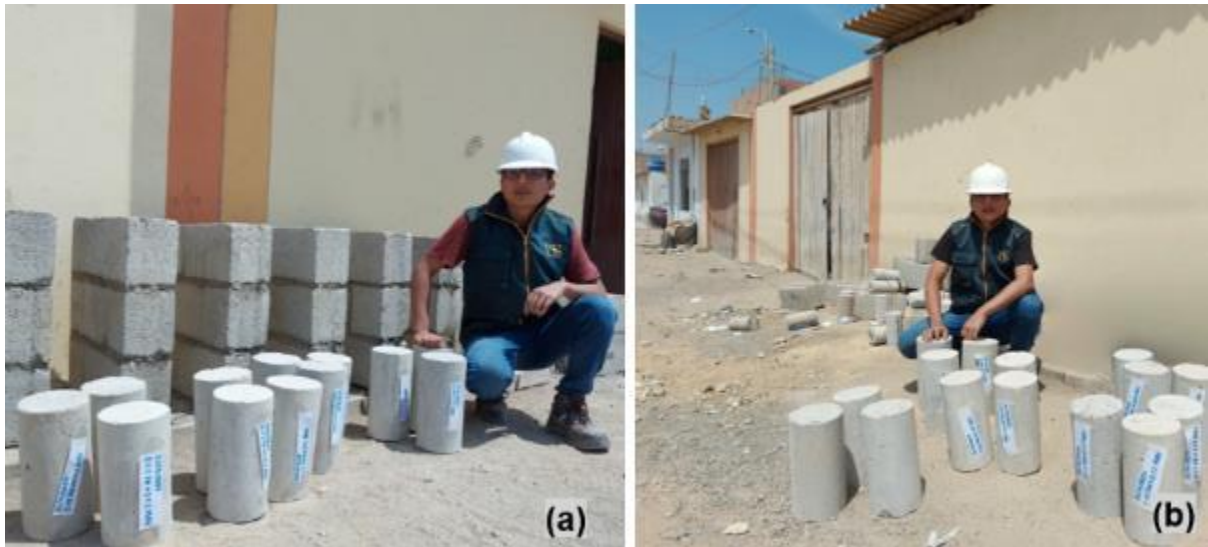
Foto 9. (a) Probetas de concreto con fibras de nylon y (b) Probetas de concreto con fibras de nylon combinado con mucílago de aloe vera
