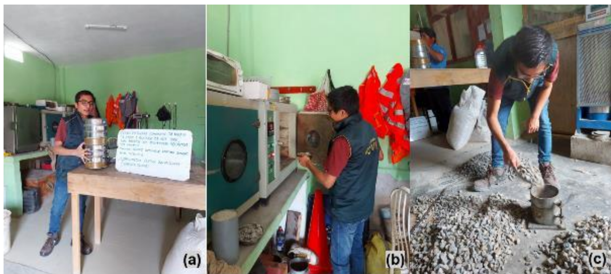
Foto 2. Ensayos al agregado grueso: (a) Granulometría, (b) Contenido de humedad y (c) Peso Unitario Suelto
