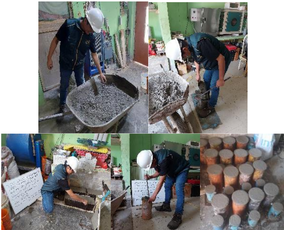
Foto 8. Evaluación de las propiedades del concreto fresco y elaboración de probetas
