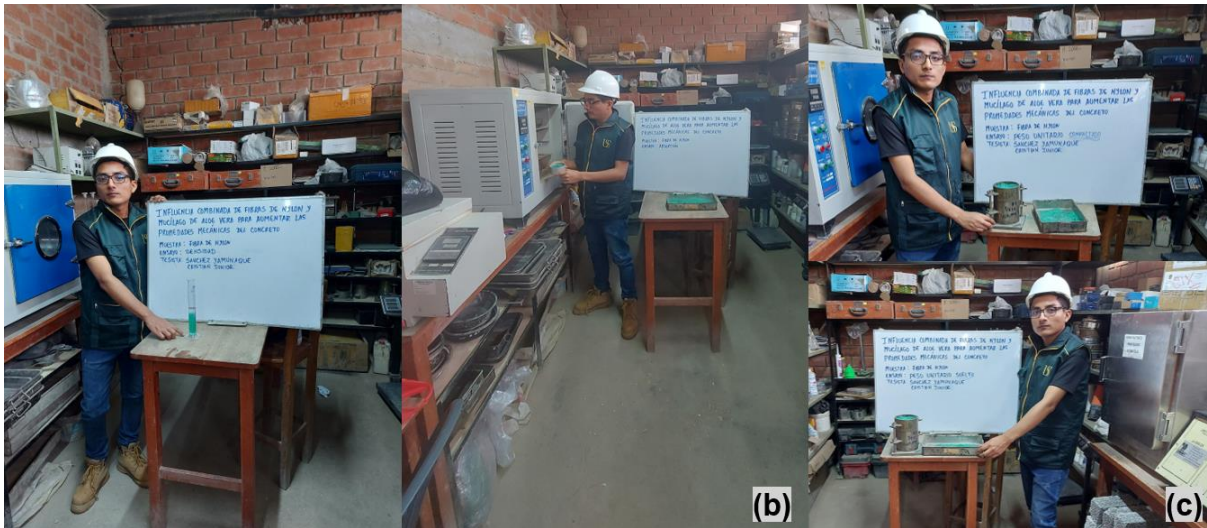
Foto 4. Ensayos a las fibras de nylon: (a) Densidad, (b) Contenido de humedad y (c) Peso Unitario Suelto y Compactado
