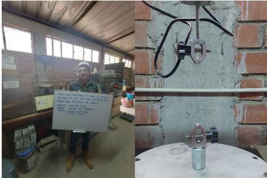
Foto 5. Ensayo de tensión a las fibras de nylon
