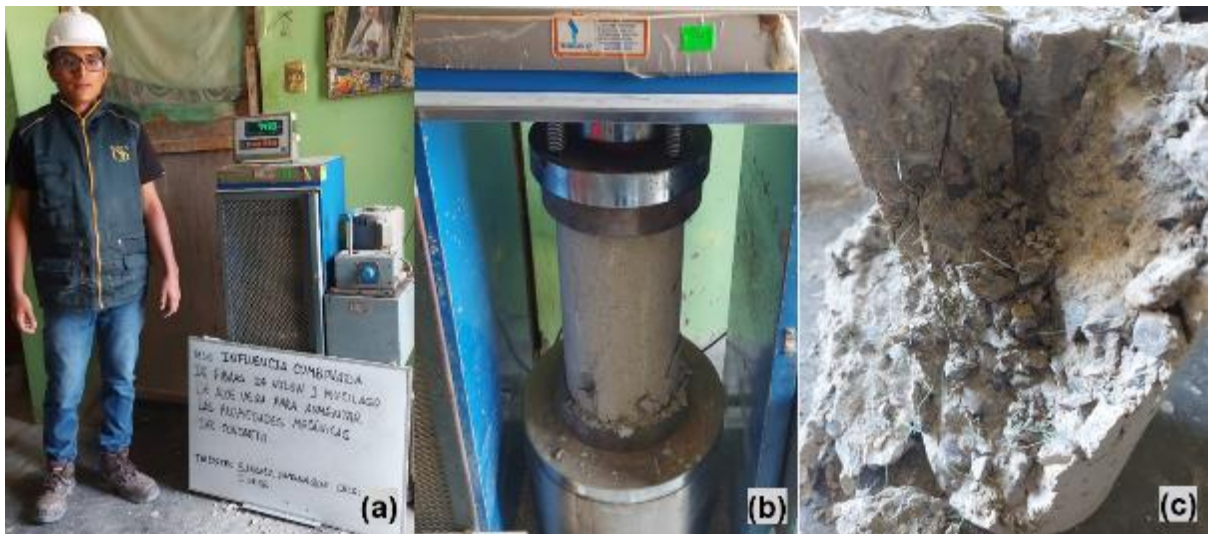
Foto 10. (a) Ensayo de resistencia a la compresión, (b) Rotura a compresión y (c) Vista interna óptima de fibra de nylon y mucílago de aloe vera
