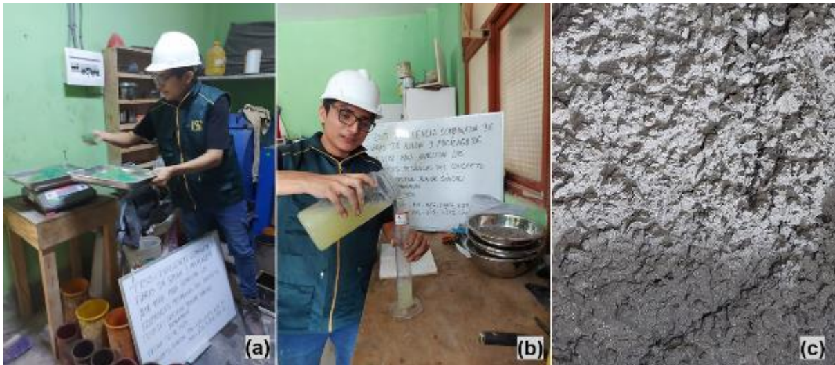
Foto 7. (a) Proporción de fibras de Nylon, (b) Proporción de Mucílago de aloe vera y (c) Insumos adicionados al concreto
