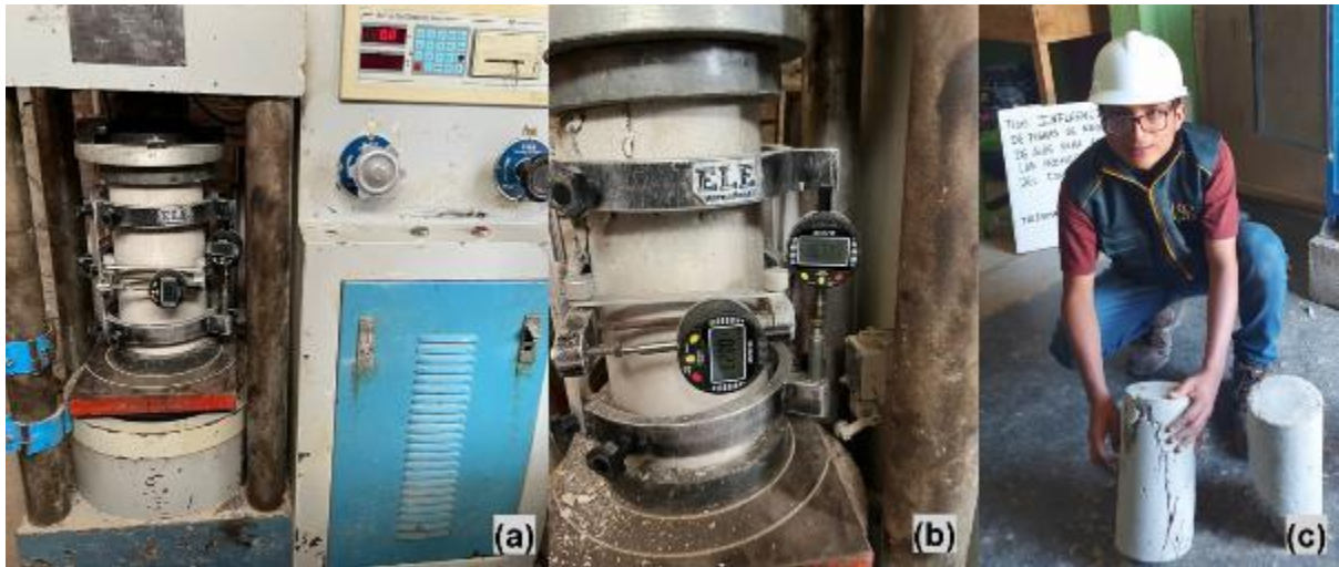
Foto 13. (a) Ensayo de módulo de elasticidad, (b) Aplicación de carga y (c) Vista de probeta óptima de fibra de nylon y mucílago de aloe vera
