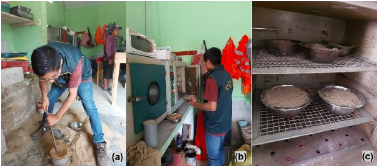
Foto 3. Ensayos al agregado fino: (a) Peso Unitario Compactado, (b) Contenido de humedad y (c) Muestras de agregados en horno
