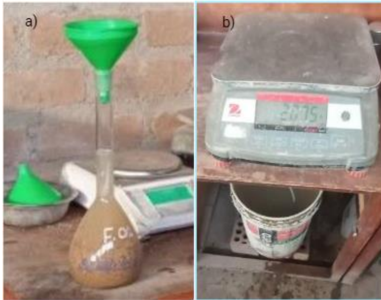
Fig. 11. Ensayo de absorción de a) arena y b) grava.
