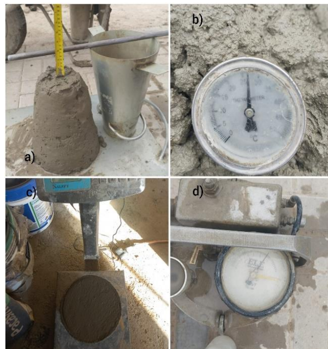
Fig. 13. Prueba físicos de: a) slump, b) temperatura, c) peso unitario y d) contenido de aire.
