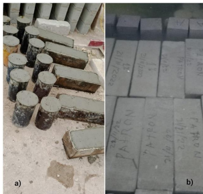
Fig.14. a) Vaciado y b) curado de probetas y vigas.
