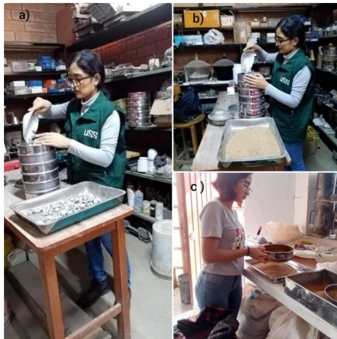
Fig. 10. Ensayo granulométrico de: a) arena, b) grava y c) aserrín.
