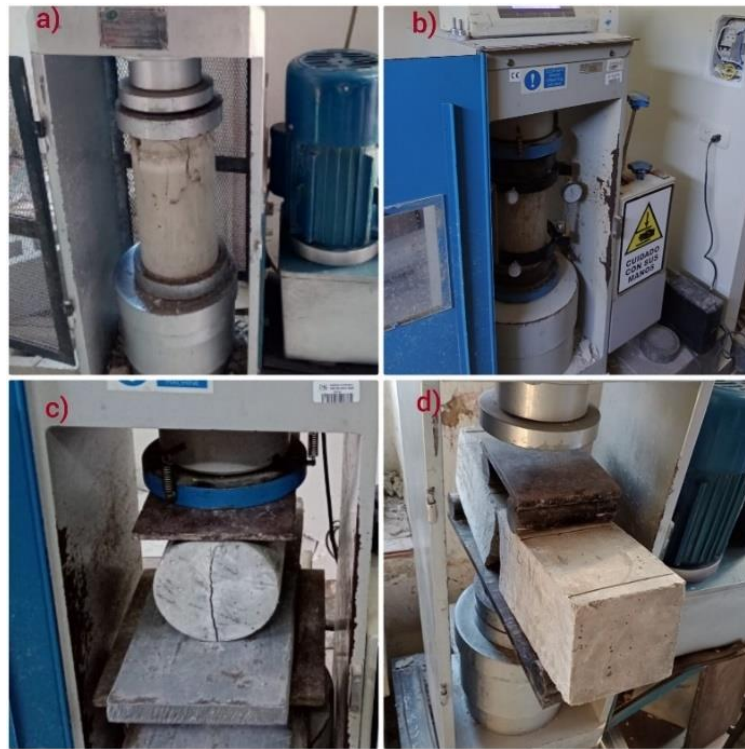
Fig. 15. Prueba de resistencia a: a) compresión, b) módulo elástico, c) tracción y d) flexión.
