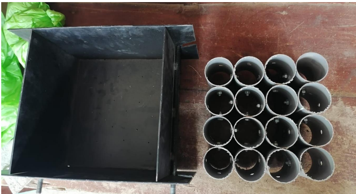
Fotografía 11. Molde metálico para prueba de compactación y CBR
