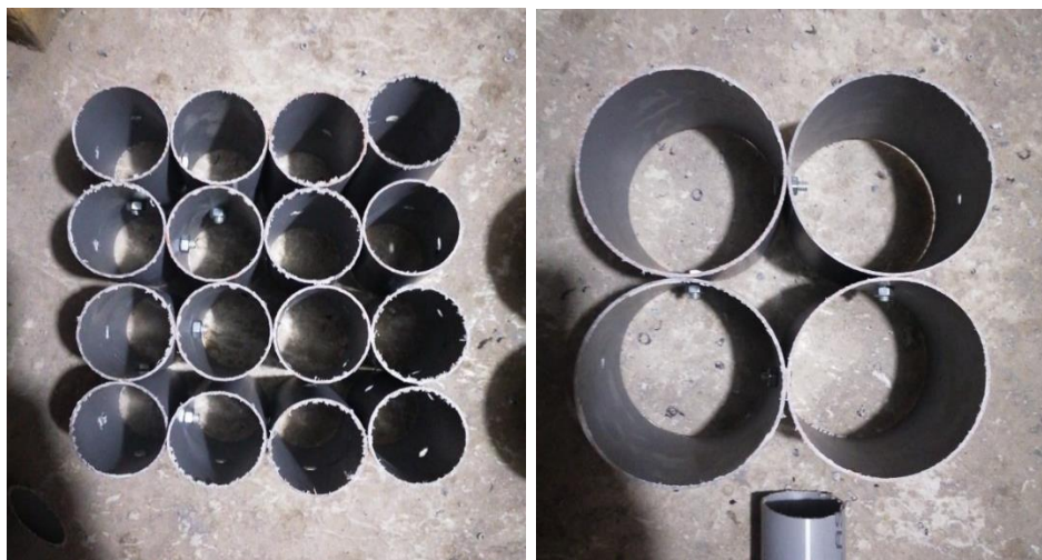
Fig. 2. Molde especial para el ensayo de compactación y CBR
