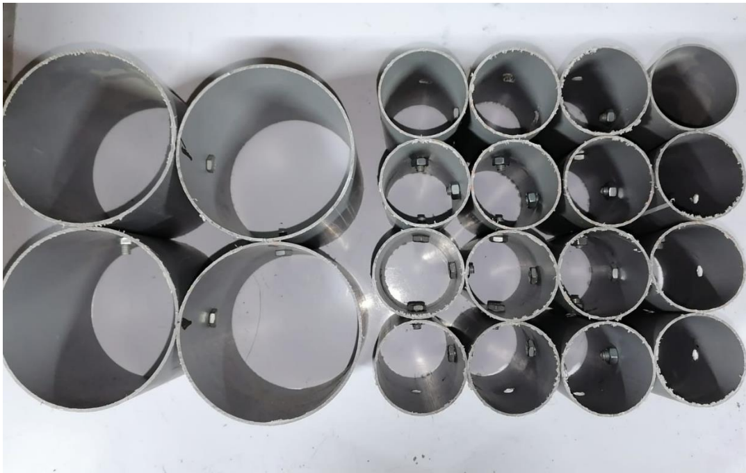
Fotografía 10. Proceso de realización de geocelda a base de tubos de PVC
