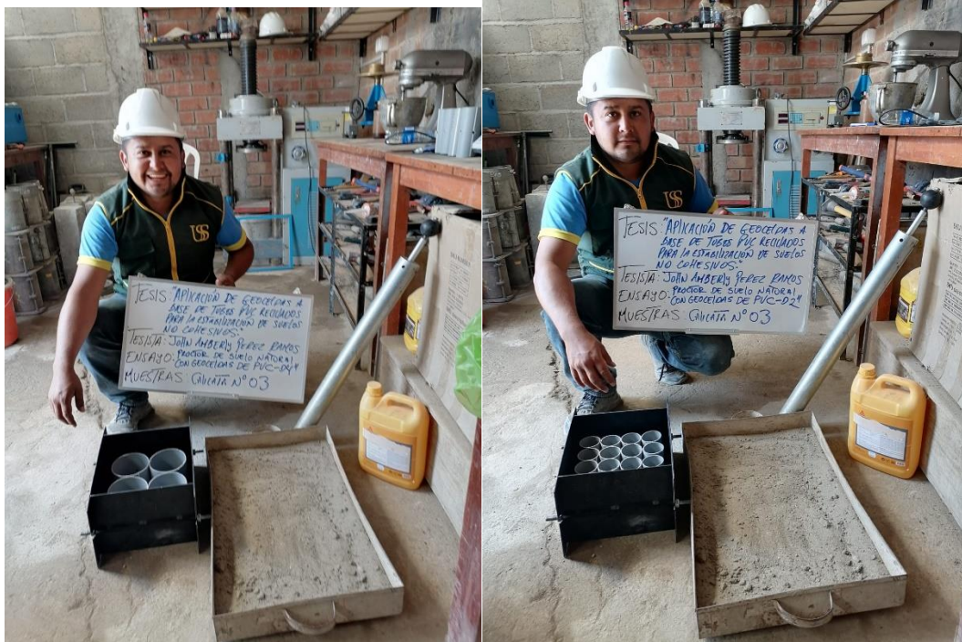
Fotografía 5. Pruebas de compactación y CBR sin y con tratamiento
