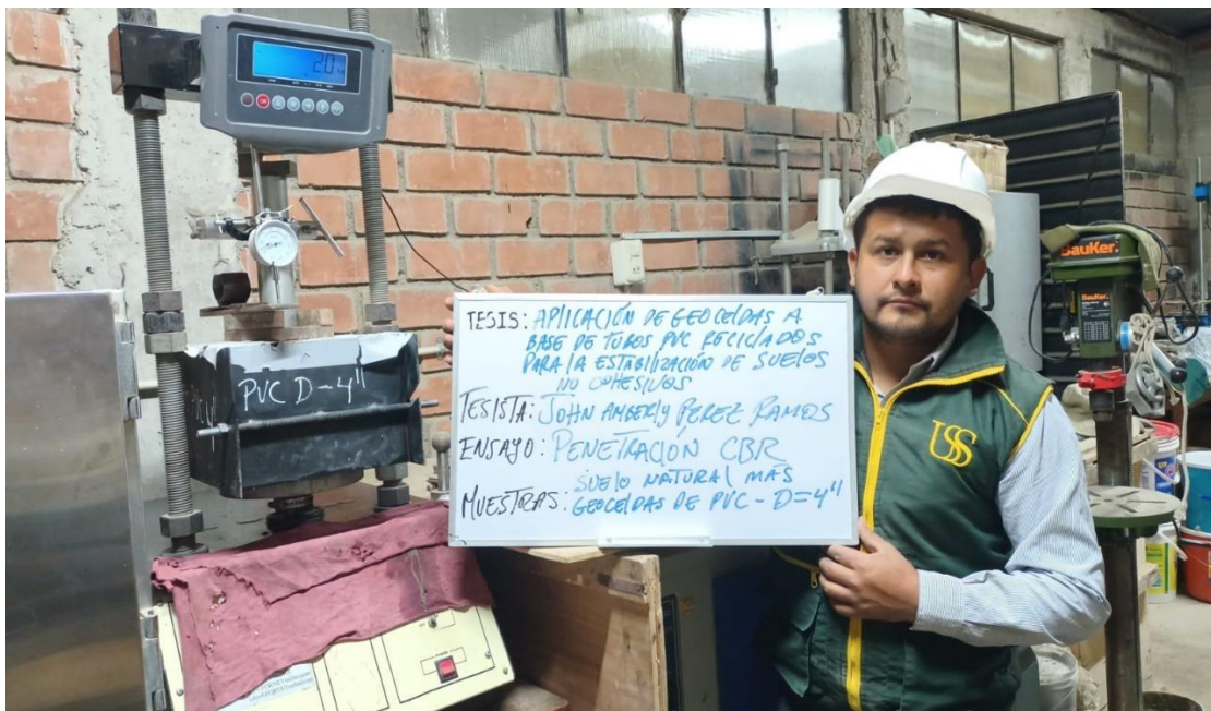
Fotografía 9. CBR para muestras de suelo reforzado con geocelda de diámetro de D.4"
