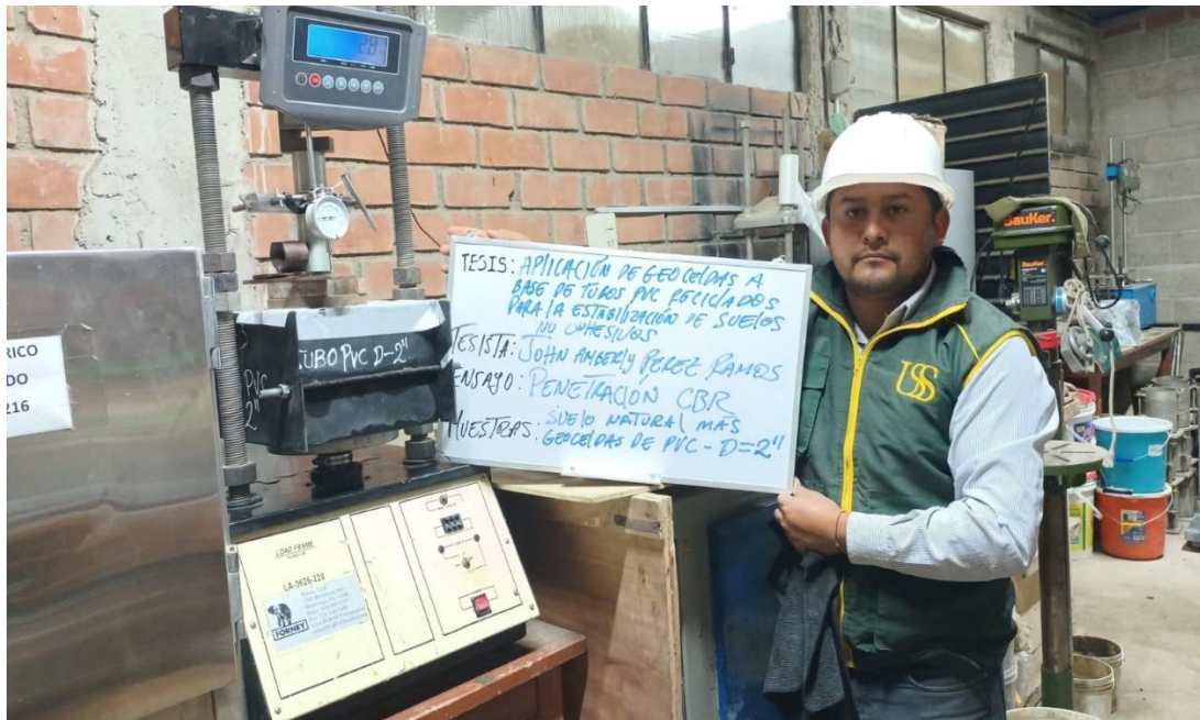
Fotografía 8. CBR para muestras de suelo reforzado con geocelda de diámetro de D.2"
