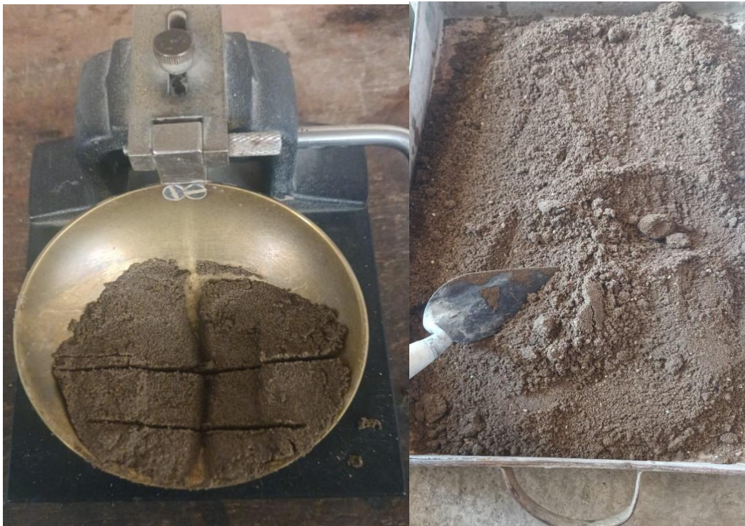
Fotografía 4. Ensayo de sales solubles
