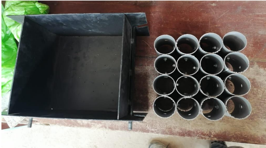
Fig. 2. Molde especial para el ensayo de compactación y CBR
