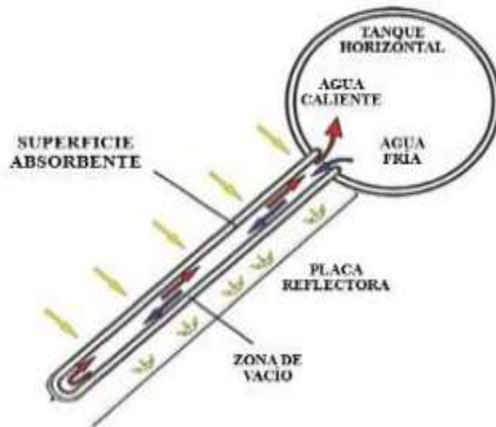
Fig. 6 Colector de tubos de vacío en forma de U
