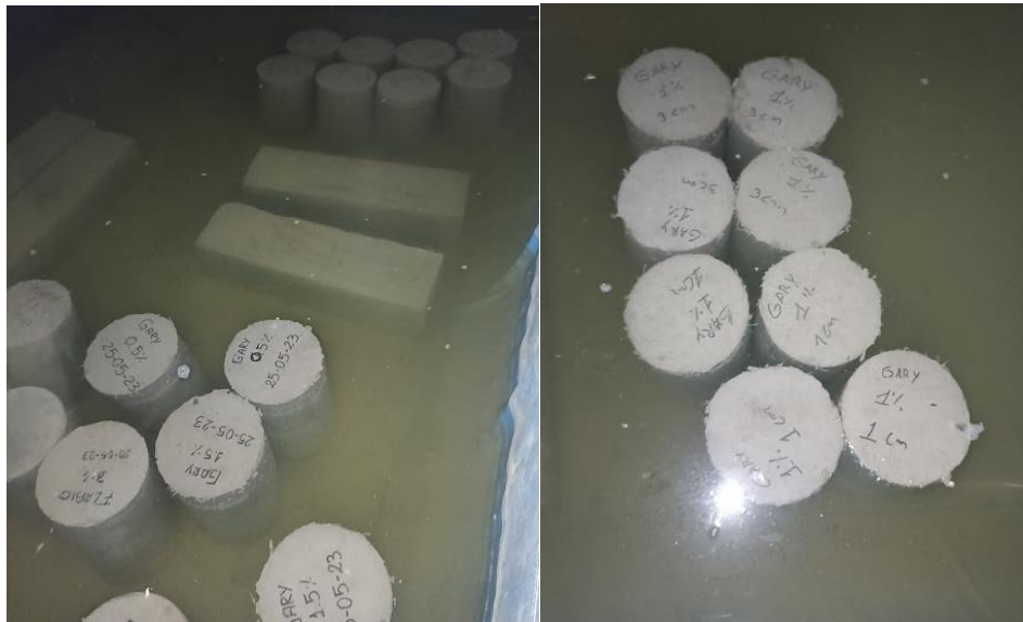
Curado de probetas a 7,14 y 28 días
