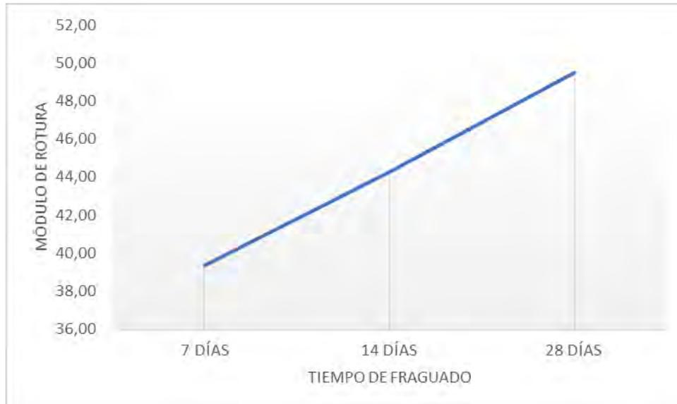
Se denota los ensayos a flexión para un concreto de  $f'c=280$  kg/cm<sup>2</sup>, del cual se obtiene un promedio de 39,33 para 7 días de fraguado, un promedio de 44,28 para 14 días de fraguado y un promedio de 49,48 para 28 días de fraguado.
