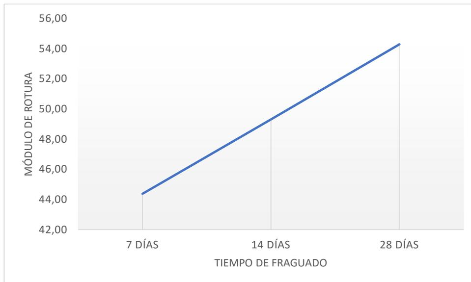
Se denota los ensayos a flexión para un concreto de  $f'c=350$  kg/cm<sup>2</sup>, del cual se obtiene un promedio de 44,36 para 7 días de fraguado, un promedio de 49,30 para 14 días de fraguado y un promedio de 54,27 para 28 días de fraguado.
