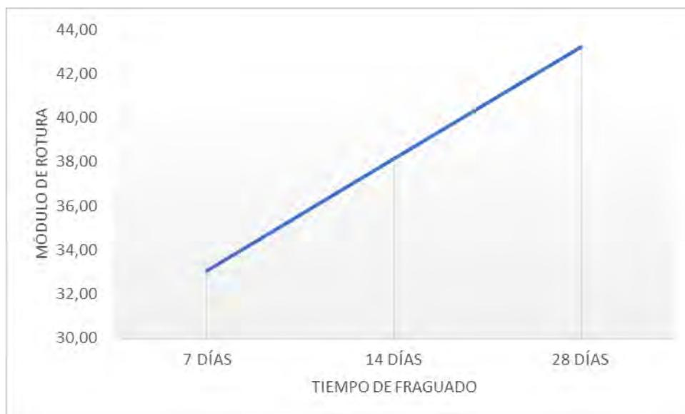
Se denota los ensayos a flexión para un concreto de  $f'c=175$  kg/cm<sup>2</sup>, del cual se obtiene un promedio de 33,05 para 7 días de fraguado, un promedio de 38,17 para 14 días de fraguado y un promedio de 43,22 para 28 días de fraguado.
