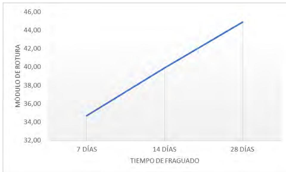
Se denota los ensayos a flexión para un concreto de  $f'c=210$  kg/cm<sup>2</sup>, del cual se obtiene un promedio de 34,66 para 7 días de fraguado, un promedio de 39,90 para 14 días de fraguado y un promedio de 44,91 para 28 días de fraguado.
