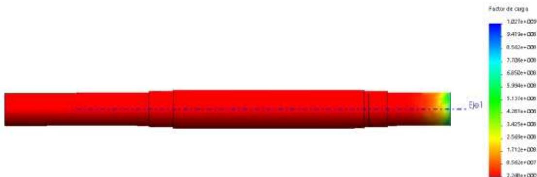
El resultado del análisis del factor de seguridad bajo el criterio de fatiga de Goodman Modificado nos indica que el valor mínimo es de 2.248, valor que es mayor a 1; por tanto, el eje no fallará a fatiga para una carga totalmente invertida.
