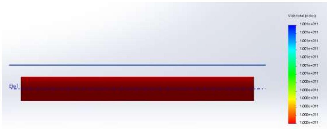
Según los resultados en la figura 45, el ciclo de vida mínimo para este diseño es de  $1 \times 10^{11}$ , por tanto, se puede interpretar que el diseño tiene una vida infinita.
