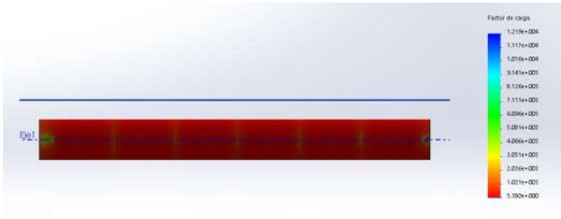
El factor de seguridad por fatiga para el pin fue de 5.78, valor que se encuentra dentro de los parámetros permisibles, por tanto, el diseño no fallará.
