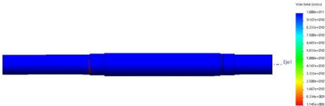
Considerando necesario el análisis del ciclo de vida bajo el criterio de fatiga de Goodman Modificado, podemos ver que el valor mínimo es de  $1.45 \times 10^6$  ciclos, siendo este valor considerado para una vida infinita; por tanto, el eje no fallará a fatiga para una carga totalmente invertida.
