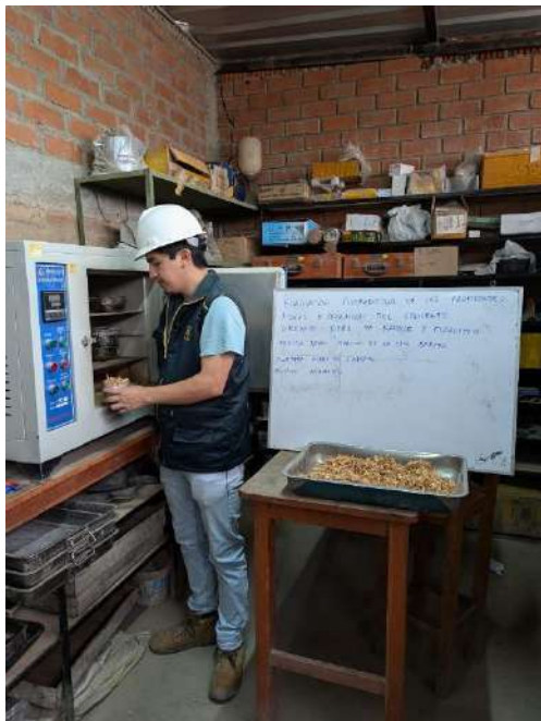
Fotografía 2. Evaluación de las propiedades de las fibras de faique y eucalipto
