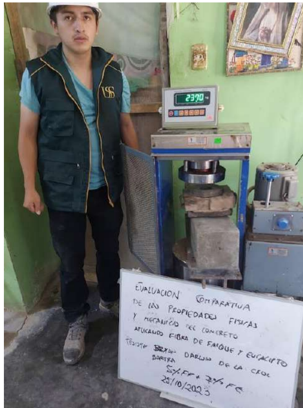
Fotografía 8. Evaluación de la resistencia a la flexión del concreto
