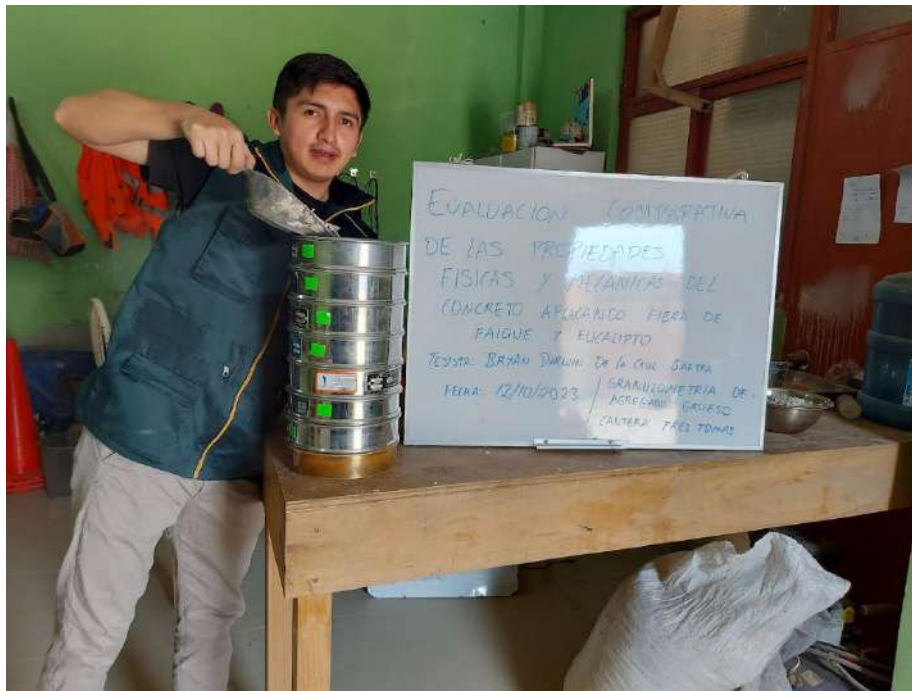
Fotografía 4. Evaluación de los agregados fino y grueso
