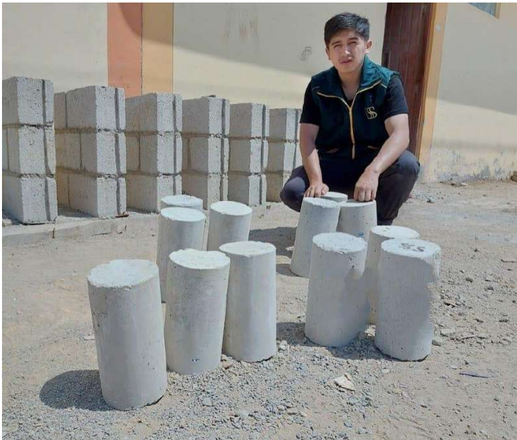
Fotografía 6. Probetas cilíndricas y prismáticas de concreto
