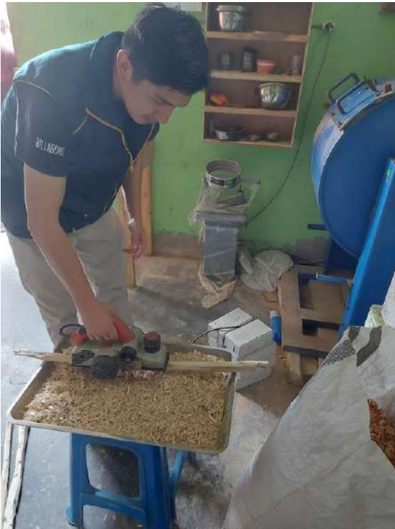
Fotografía 3. Obtención de las fibras de faique y eucalipto
