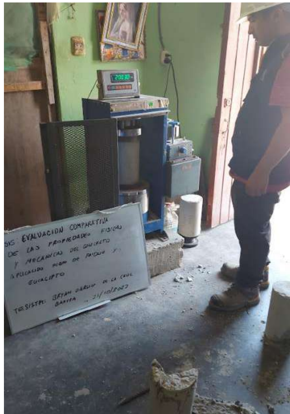
Fotografía 7. Evaluación de la resistencia a la compresión del concreto
