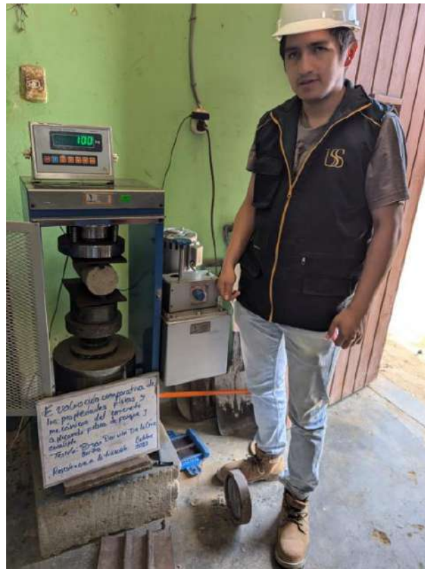
Fotografía 9. Evaluación de la resistencia a la tracción del concreto
