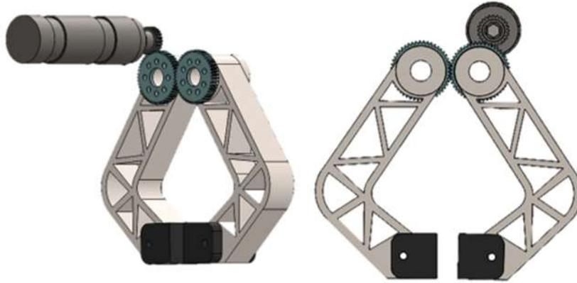
Fig 18. Sistema de transmisión de engranajes.
