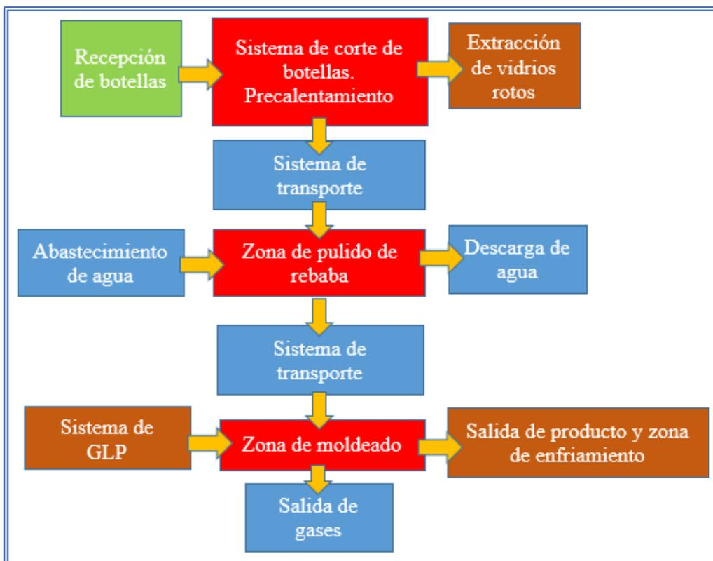
Fig 7. Principales sistemas tomados en cuenta para el diseño de máquina de corte, pulido y moldeo.
