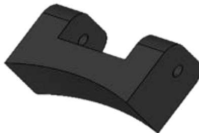
Fig 17. Modelo de Silicona para pinza sujetadora de botella.
