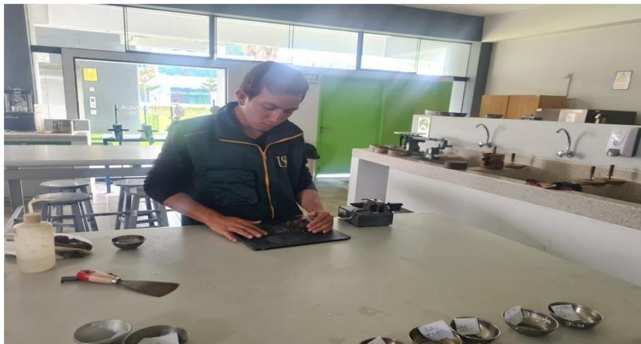
***Ilustración 8. Ensayo de limite Liquido***
