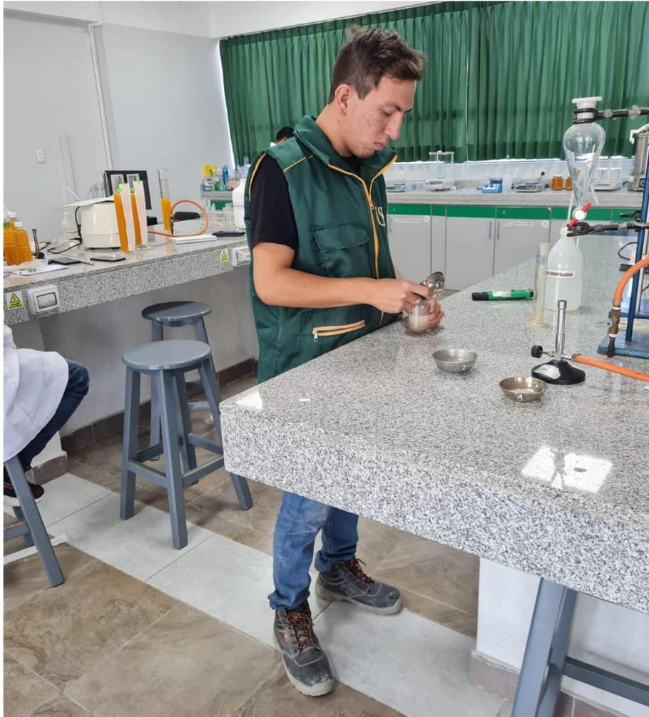
***Ilustración 13. Ensayo de evaluación de PH del suelo con cal***
