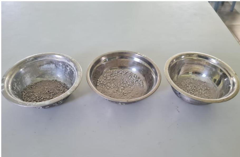
***Ilustración 12. Suelo con cal para determinación de PH***
