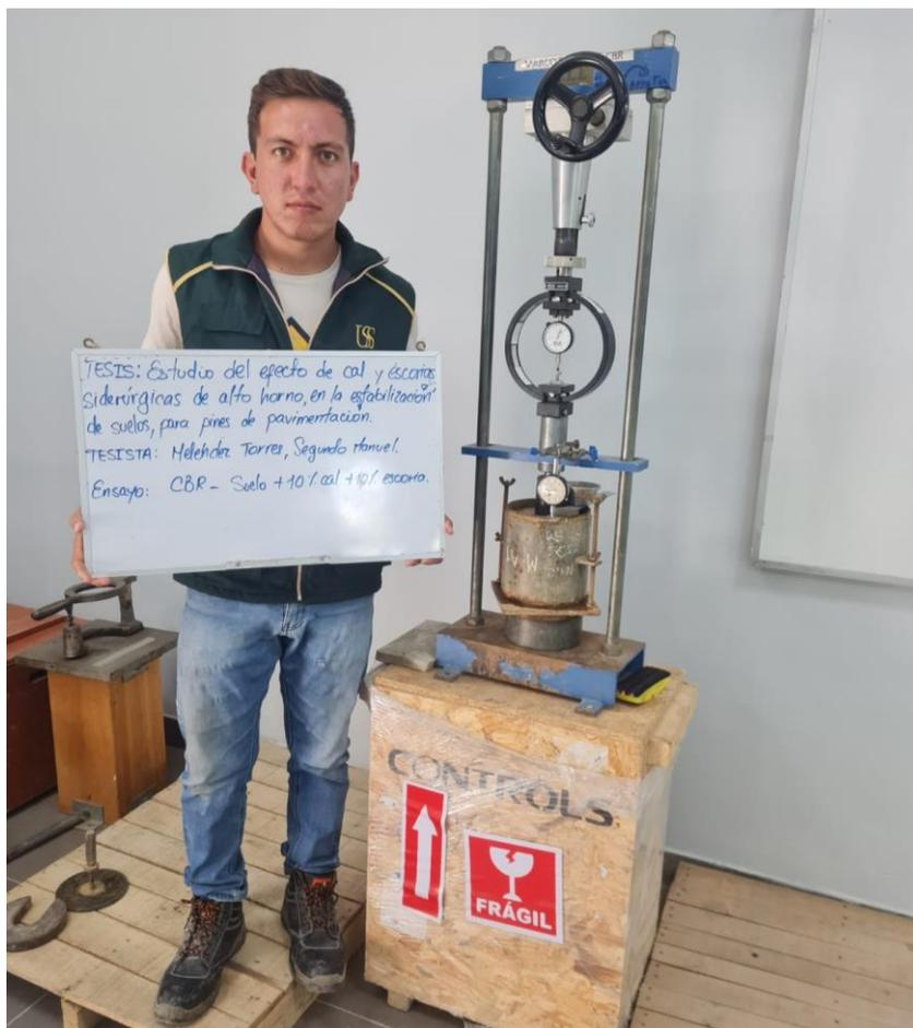
**Ilustración 17. Ensayo de CBR**
