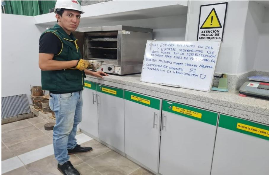
**Ilustración 9. Muestras del horno para contenido de humedad seca**
