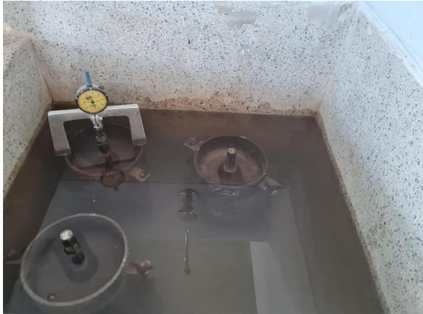
**Ilustración 16. Curado de muestras para ensayo de CBR**
