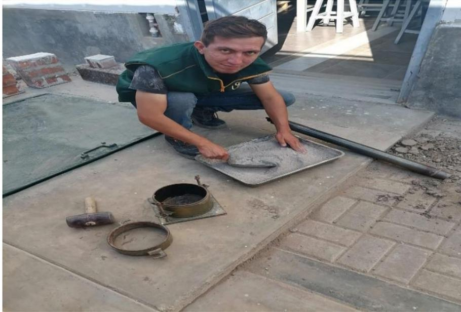
***Ilustración 11. Preparación de muestras para Proctor***
