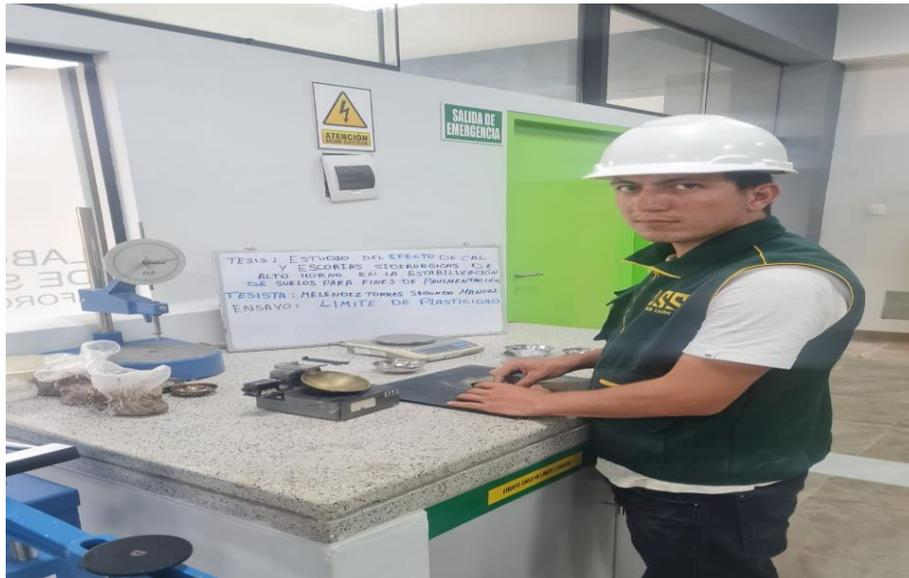
***Ilustración 7. Ensayo de limite plástico***
