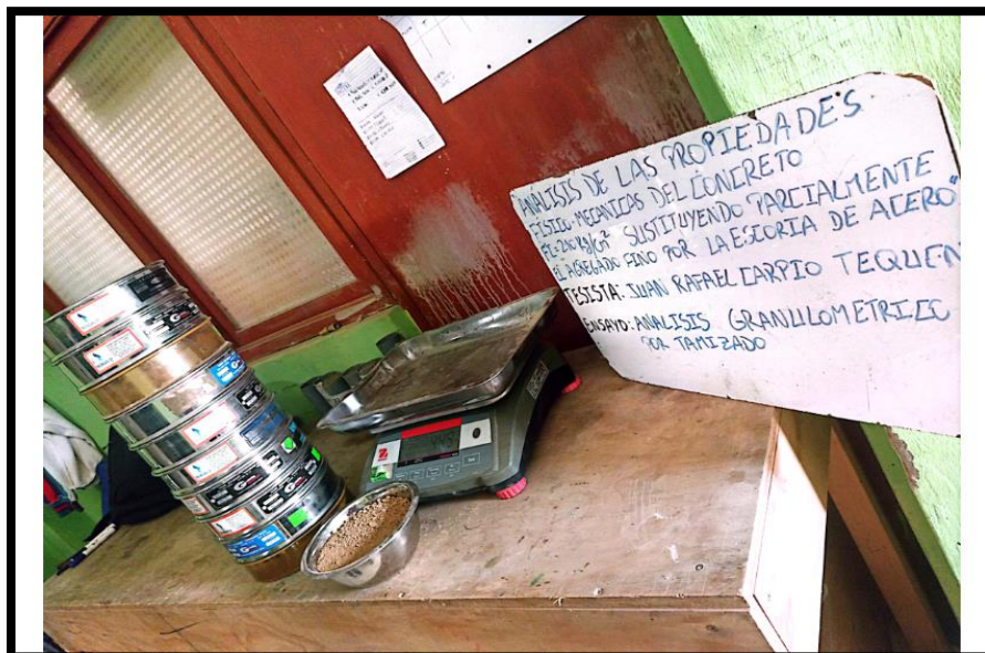
Fig. 12. Granulometría del agregado fino
