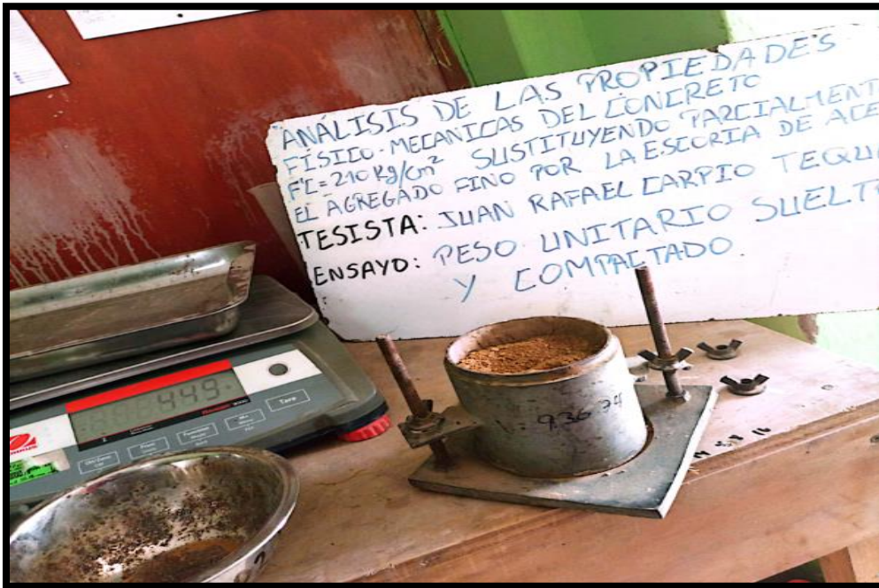
Fig. 19. Peso unitario agregado fino
