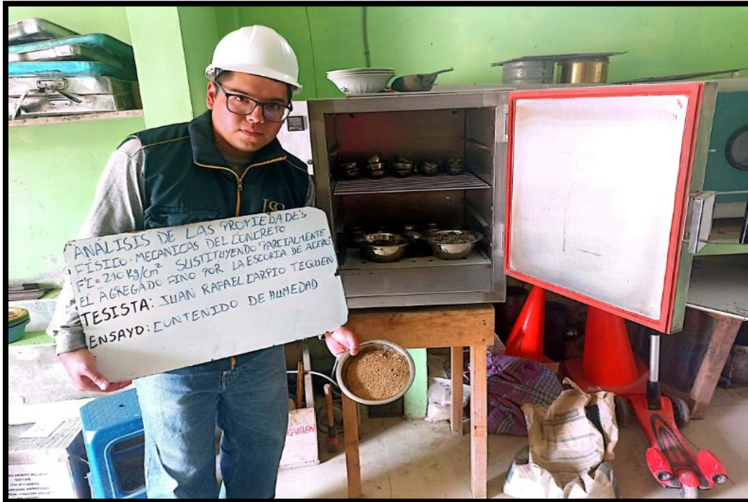
Fig. 15. Contenido de humedad del agregado fino
