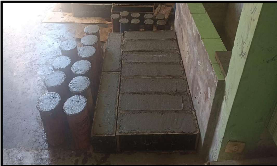
Fig. 30. Muestras de concreto colocadas en moldes
