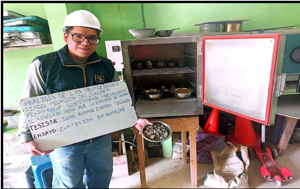
Fig. 16. Contenido de humedad del agregado grueso
