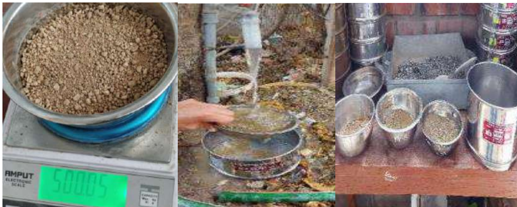
A. Peso de muestra secada al horno, Lavado de muestra por malla N°200 y Colocado al horno de la muestra
