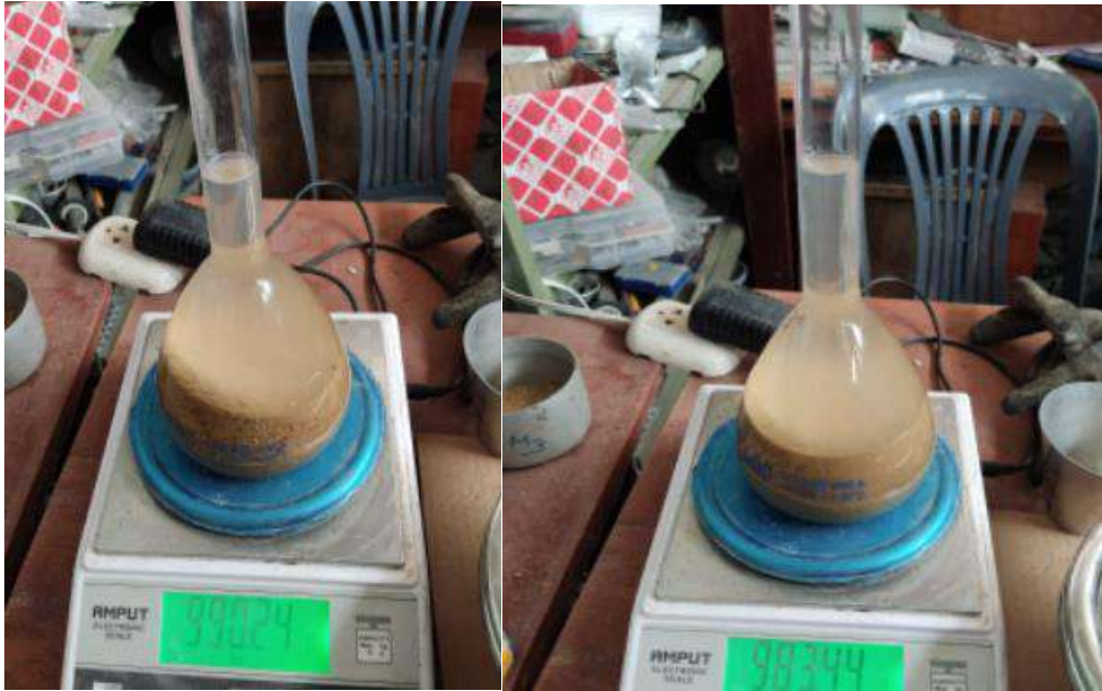
B. Se pesa la fiola con agua y muestra de agregado fino
