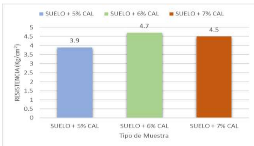
Fig. 8. Resistencia del suelo con la adición de cal
