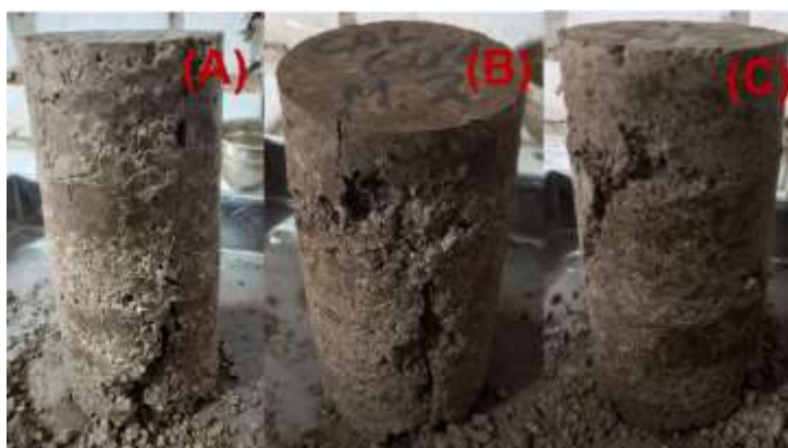
Fig. 9. Probetas de suelo con adición de cal
