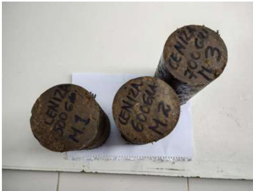
Probetas de suelo con adición de ceniza de aserrín
