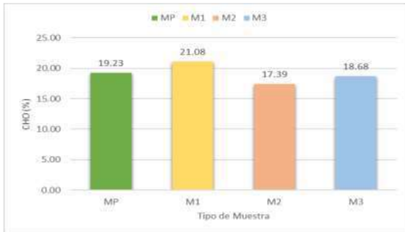
Fig. 13. Contenido de humedad óptima de cada muestra
