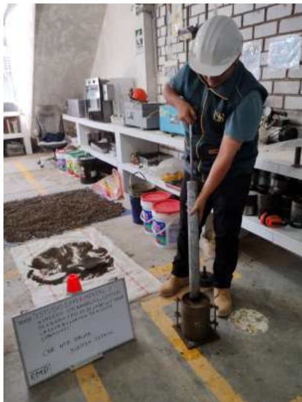
Proceso de ensayo CBR
