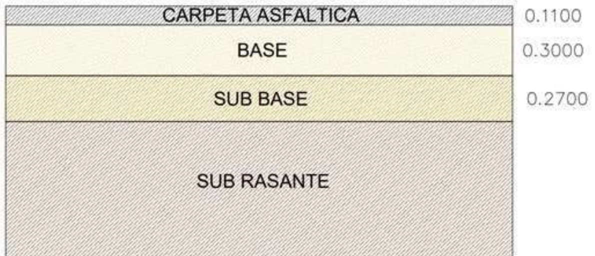
Fig. 23. Espesores finales para el diseño de pavimento
