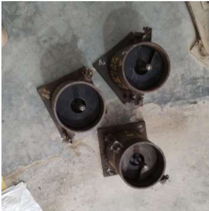
Moldes de CBR previo a ingresar a la poza de curado
