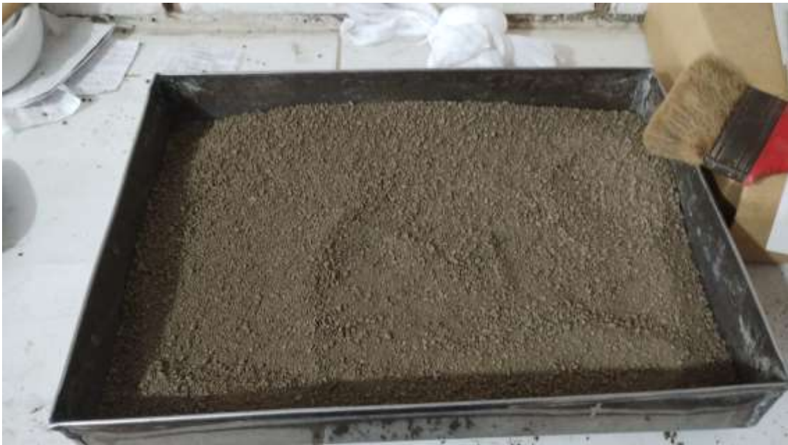
Muestra de suelo para ensayo de Proctor Modificado
