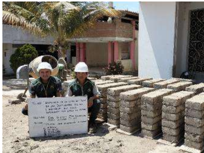
Muestra de Muretes para Compresión en Diagonal
