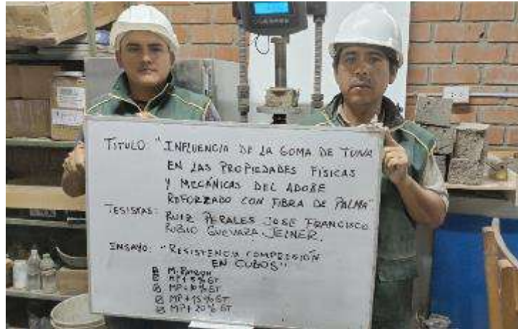
Ensayo Resistencia a la Compresión en Cubos.
