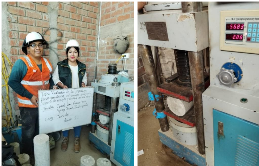
Fotografía 42 y 43. Ensayo de tracción al concreto endurecido
