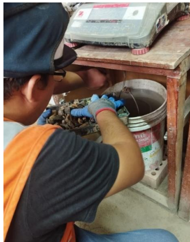
Fotografía 18 y 19. Ensayo granulométrico para el aserrín de eucalipto y viruta de madera tornillo
