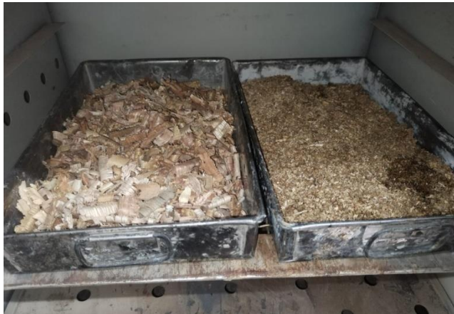
Fotografía 24 y 25. Ensayo de peso unitario para el aserrin y la viruta
