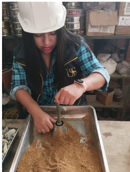
Fotografía 12 y 13. Ensayo de peso unitario
