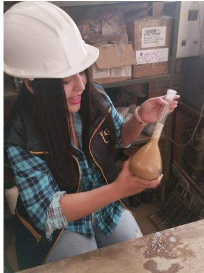
Fotografía 16 y 17. Ensayo de peso específico y absorción
