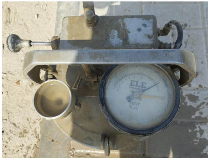
Fotografía 41. Ensayo de contenido de aire al concreto fresco
