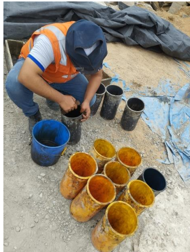
Fotografía 30, 31 y 32. Llenado de probetas cilíndricas y viguetas
