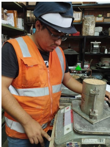
Fotografía 24 y 25. Ensayo de peso unitario para el aserrin y la viruta
