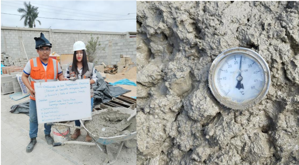
Fotografía 41. Ensayo de contenido de aire al concreto fresco
