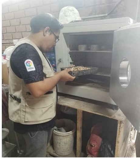
Fotografía 22 y 23. Ensayo de contenido de humedad para el aserrín y la viruta
