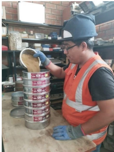
Fotografía 8 y 9. Ensayo de granulometría para agregado fino
