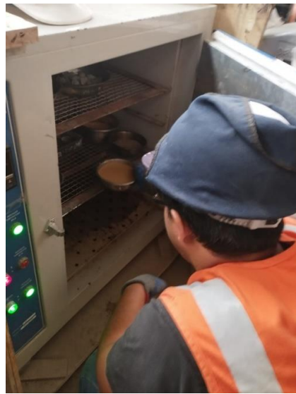
Fotografía 14 y 15. Ensayo de contenido de humedad
