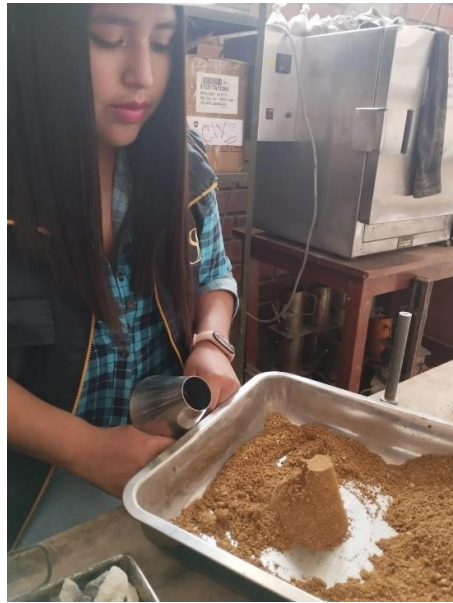
Fotografía 14 y 15. Ensayo de contenido de humedad
