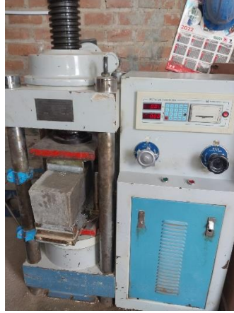
Fotografía 44, 45, 46 y 47. Ensayo de compresión, flexión y módulo de elasticidad al concreto endurecido
