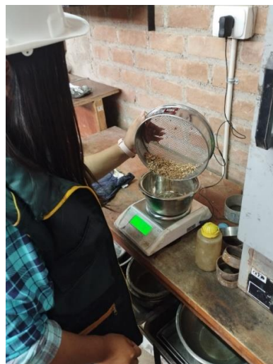
Fotografía 18 y 19. Ensayo granulométrico para el aserrín de eucalipto y viruta de madera tornillo
