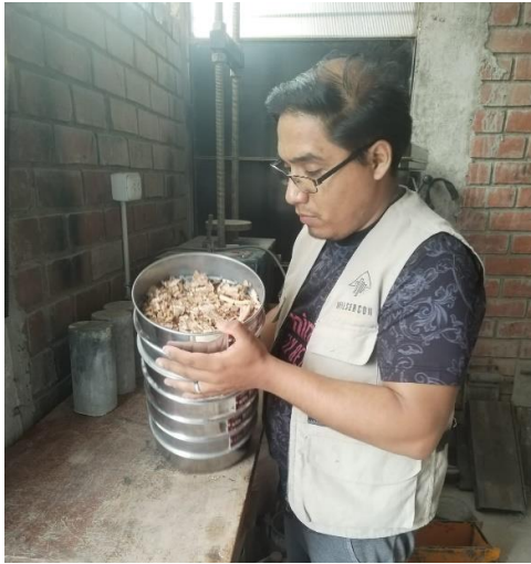
Fotografía 20 y 21. Ensayo de peso específico y absorción para la viruta
