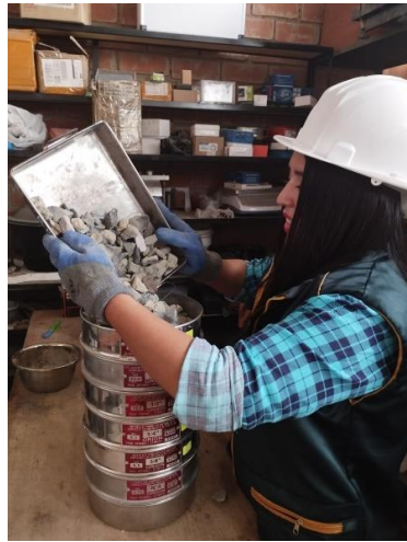
Fotografía 10 y 11. Ensayo de granulometría para agregado grueso
