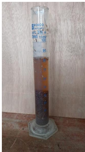
Fotografía 20 y 21. Ensayo de peso específico y absorción para la viruta
