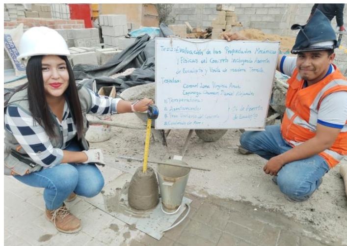
Fotografía 38. Ensayo de peso unitario al concreto fresco
