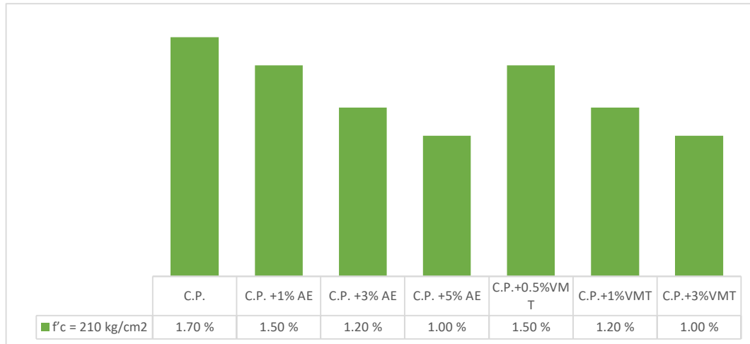
Fig. 7 Contenido de aire en el concreto fresco patrón y con adiciones de AE (1%,3%,5%) y VMT (0.5%,1%,3%).
