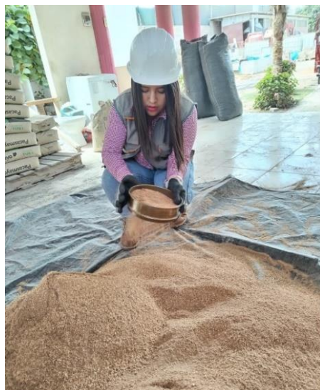
Fotografía 6 y 7. Tamizado del aserrín de eucalipto
