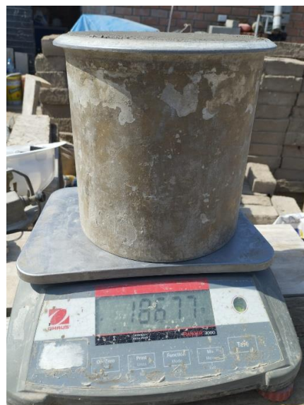
Fotografía 38. Ensayo de peso unitario al concreto fresco
