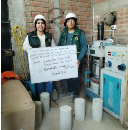
Fotografía 44, 45, 46 y 47. Ensayo de compresión, flexión y módulo de elasticidad al concreto endurecido
