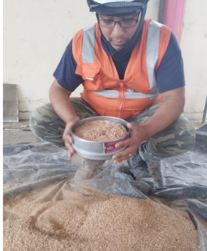
Fotografía 8 y 9. Ensayo de granulometría para agregado fino
