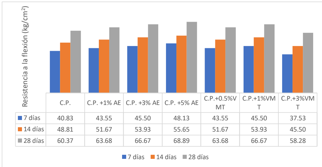
Fig. 13 Resistencia a la flexión promedio para concreto patrón adicionando AE y VMT.
