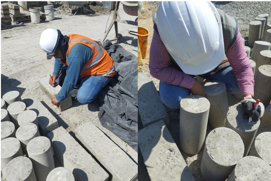
Fotografía 33, 34 y 35. Rotulado de probetas cilíndricas y viguetas
