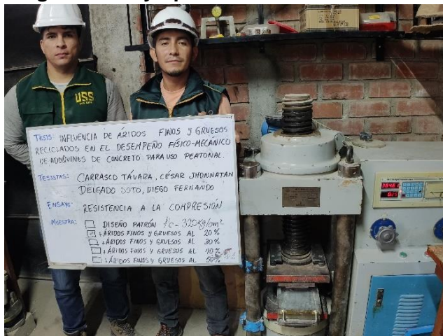
Fig. 13. Ensayo por resistencia a la compresión.
