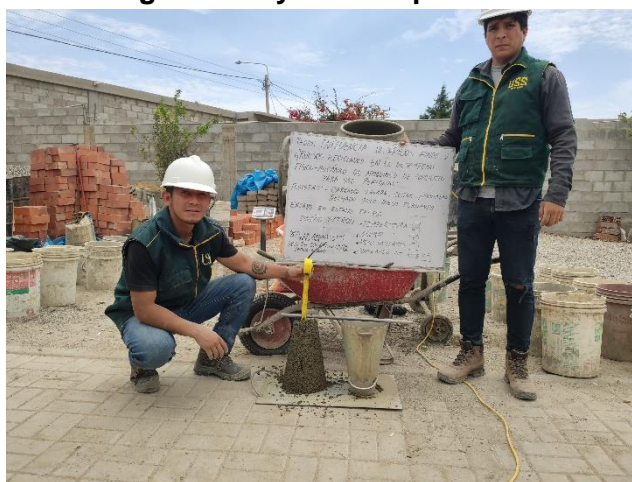
Fig. 10. Ensayo de asentamiento Slump.
