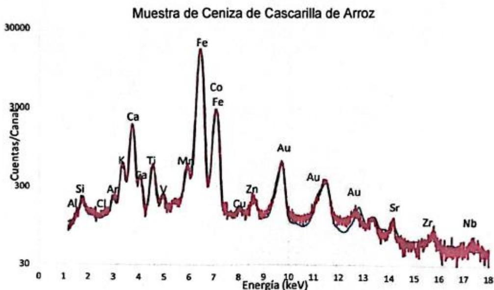
Figura 1. Espectro de FRXDE de ceniza de cascarilla de arroz en escala semi logarítmica. Incluye el pico de Ar del aire y los picos de los rayos-X primarios de Au dispersados por la muestra.
