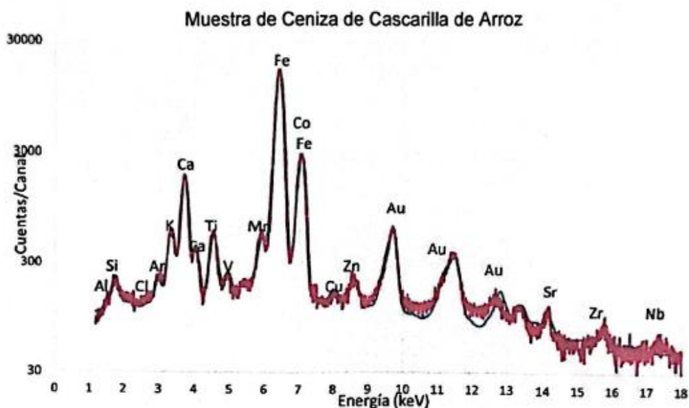
Figura 1. Espectro de FRXDE de ceniza de cascarilla de arroz en escala semi logarítmica. Incluye el pico de Ar del aire y los picos de los rayos-X primarios de Au dispersados por la muestra.
