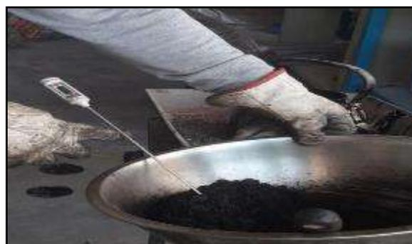
**Temperatura de mezcla asfáltica**
