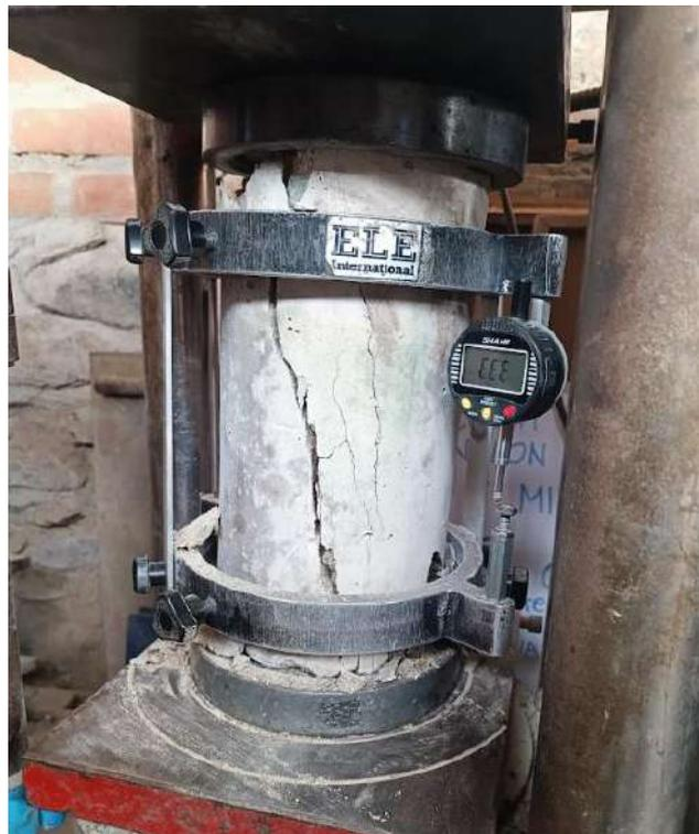
Ensayo módulo de elasticidad
