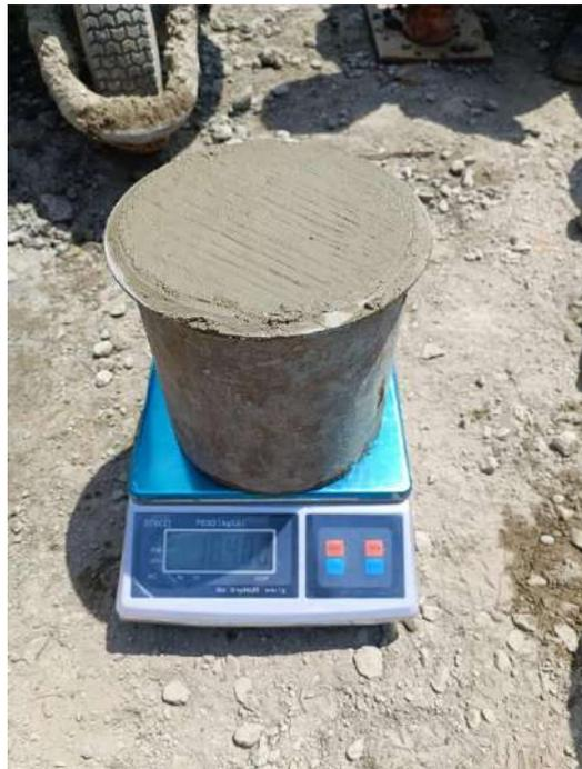
Ensayo de peso unitario del concreto.
