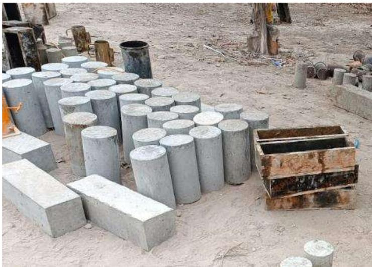
Desmoldado de cilindros y vigas de concreto.
