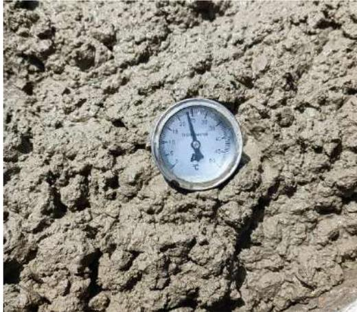
Ensayo de temperatura del concreto en estado fresco.
