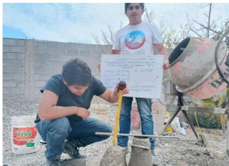
Ensayo de asentamiento del concreto en estado fresco.
