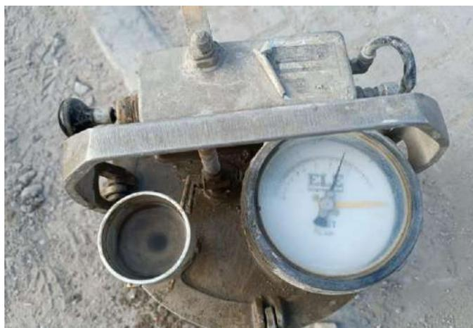
Ensayo de contenido de aire.
