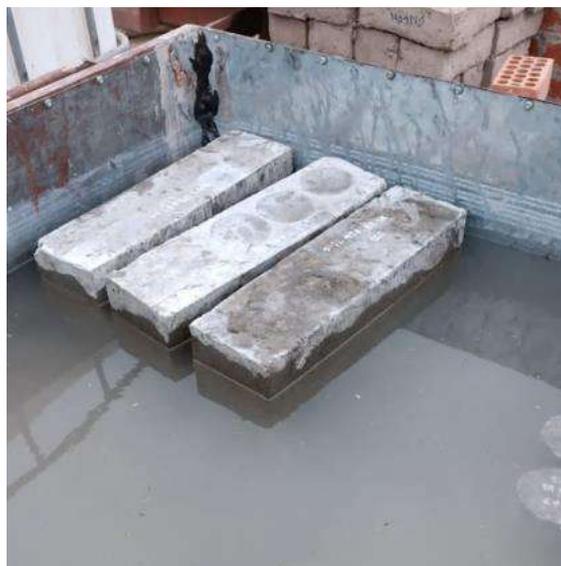
Curado de cilindros y vigas de concreto.
