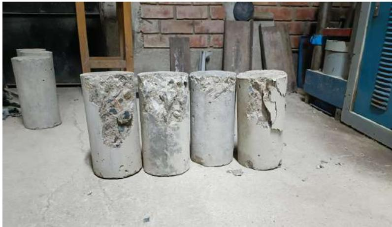
Ensayo de resistencia a la compresión
