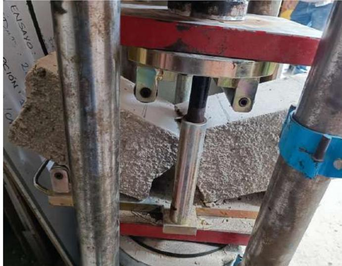
Ensayo de resistencia a la flexión.
