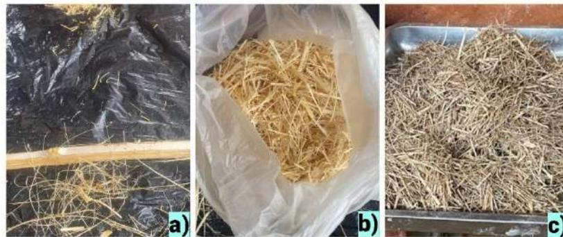
Fig. 1. Material Bambú (a) obtención del material, b) convertido en fibra, c) tratamiento.
