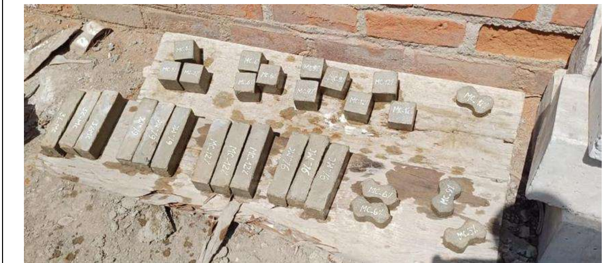
FOTO- muestras (cubos, tracción y vigas)
