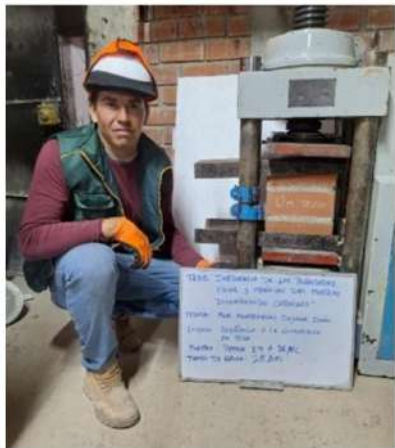
FOTO- resistencia a la compresión en pilas (7, 14 y 28 días)
