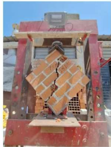
FOTO- resistencia a la compresión en pilas (7, 14 y 28 días)
