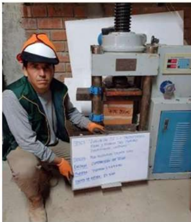
FOTO- resistencia a la compresión en pilas (7, 14 y 28 días)
