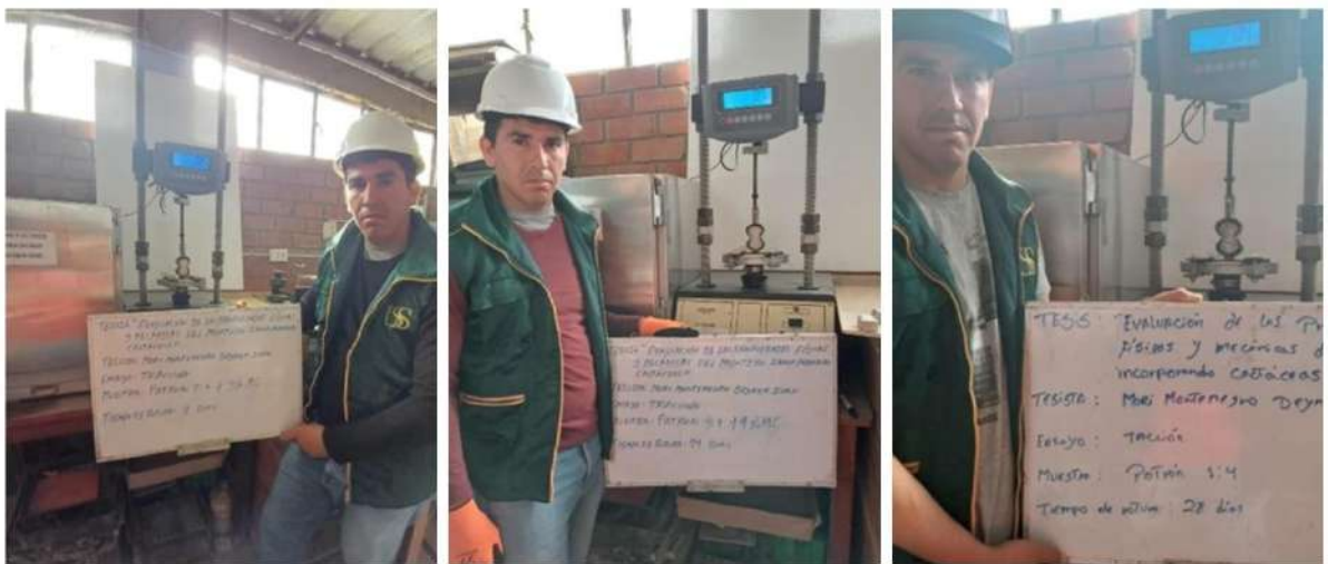
FOTO- ensayo de tracción (7, 14 y 28 días)
