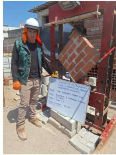
FOTO- ensayo de compresión diagonal de muretes
