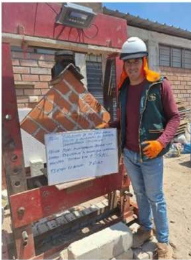
FOTO- resistencia a la compresión en pilas (7, 14 y 28 días)
