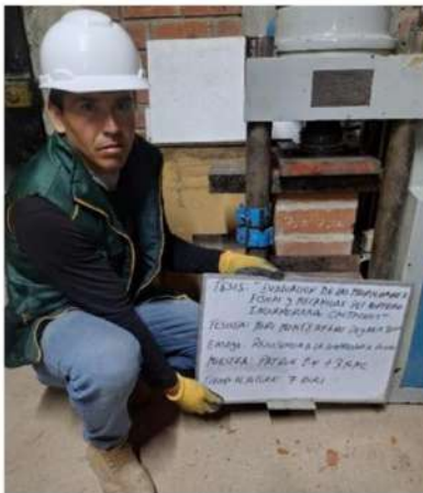
FOTO- resistencia a la compresión en pilas (7, 14 y 28 días)
