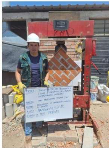
FOTO- resistencia a la compresión en pilas (7, 14 y 28 días)
