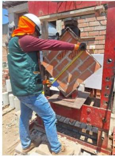
FOTO- ensayo de compresión diagonal de muretes
