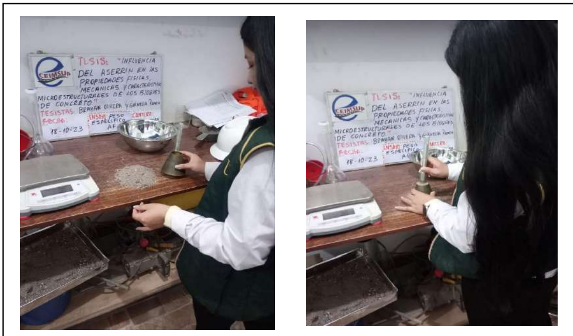
Fig 41 Apisonado de la muestra del agregado fino en el molde conico y desmolde.
