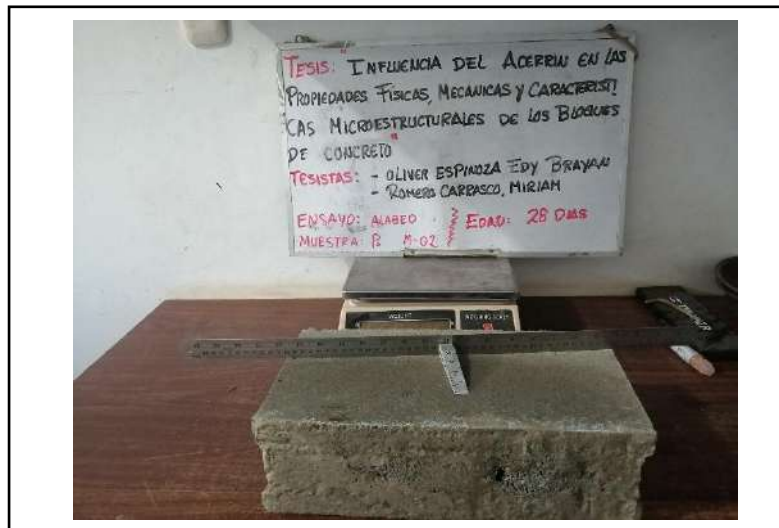
Fig 68 . Prueba de alabeo a la unidad de albañilería.
