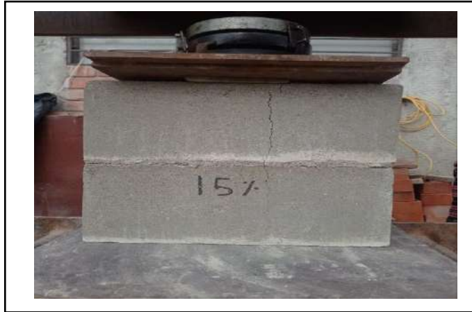
Fig 83 Falla vertical presentada en prismas de albañilería.
