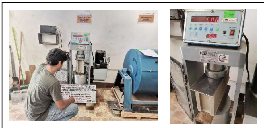
Fig 74 . Ensayo de compresión de bloques de concreto - aserrín.
