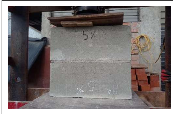
Fig 80 Ensayo de resistencia a la compresión de prismas de albañilería.
