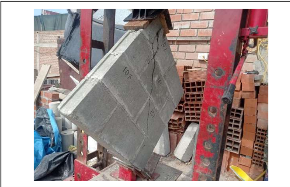
Fig 92 Falla por tracción diagonal del muerete de albañilería.
