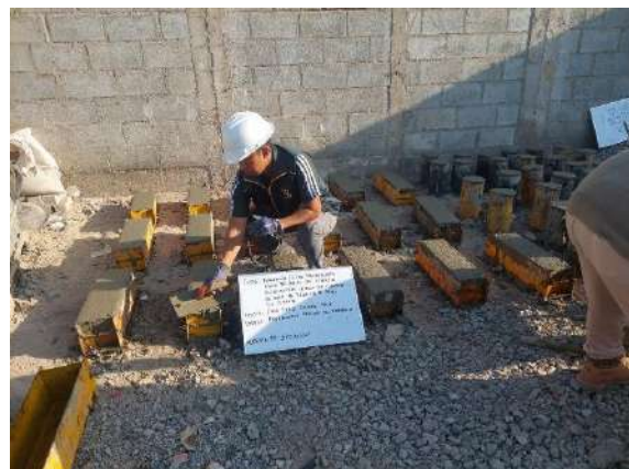
Imagen 22 - Elaboración de vigas
