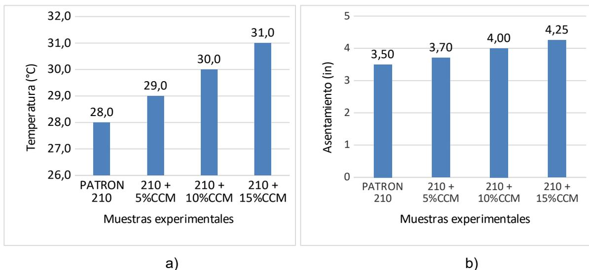
**Fig. 2.** Ensayos del concreto en estado fresco. a) Temperatura, b) Asentamiento
