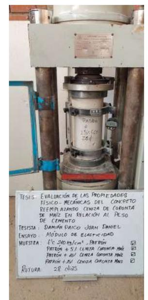
ANEXO 30: FOTO- Ensayos mecánicos del concreto- resistencia a la tracción a los
